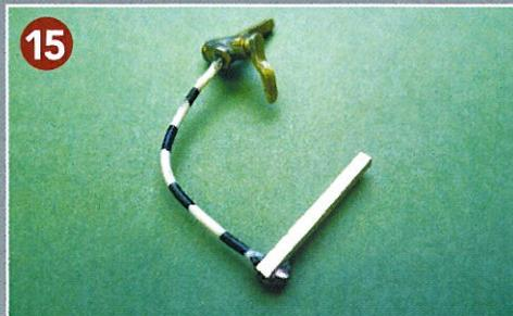
Wenn schon, denn schon auch mit solchem Detail: Der nur scheinbar unspektakuläre Bremsschlauch ist mit einem beweglichen Absperrhahn ausgerüstet.
