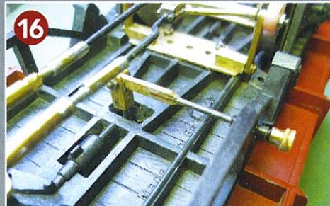
Für das Ein- und Ausschalten der Funkanlage wurde unter dem Wagenboden ein Schalter platziert, der mittels Stahldrahts und Weckerknopfes betätigt wird.
