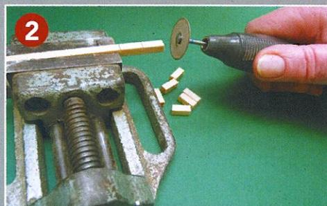
2 Zur Herstellung der Holzklötzchen aus Profilstäben eignen sich verschiedene Methoden. Mit einem Schraubstock vermindert sich das Verletzungsrisiko.
