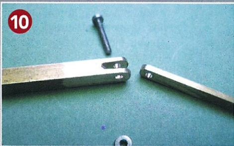
10 Es darf gefeilt, gebohrt, gemessen und poliert werden: Aus Messing-Vollmaterial bestehen diese exakt von Hand gefertigten Gelenkarme.
