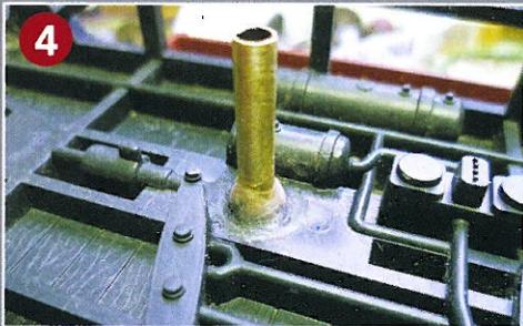
4 Unterbodenansicht: Die noch nicht gekürzte Hülse für die Bremsachse ist eingegossen und mit dem Dentalkunststoff „Pala X-Press“ zuverlässig fixiert.
