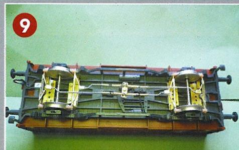
6 Gar nicht so kleiner, aber gleichwohl feiner Unterschied: Die funktionstüchtige Bremsanlage hat die Dekorationsbremse (s. Bild 4) abgelöst.
