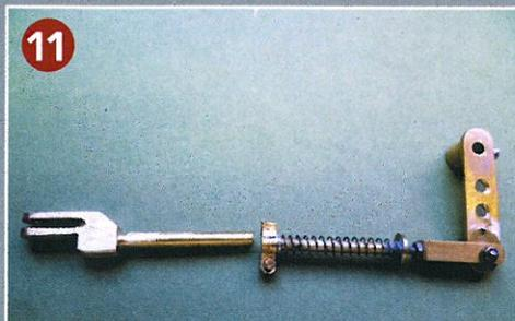
11 Waggonmitte, Blick von oben: Hier präsentiert sich das Präzisionsbremsgestänge vom Stellmotor zum Stellarm mit Ausgleichsfeder am Bremsrohr.
