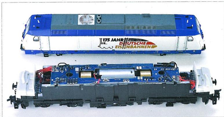
Zwei Schwungmassen sorgen für ein ruhiges Fahrverhalten und einen ausreichenden Auslauf im Falle kleiner Stromunterbrechungen.
