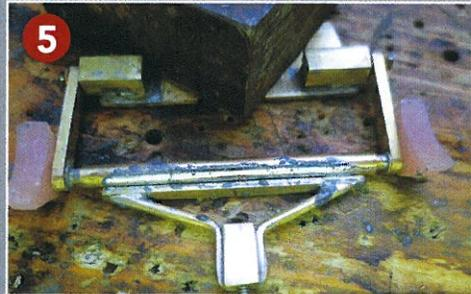
5 Wichtiges Bindeglied bei der Übertragung der Bremskraft auf die Bremsbacken: Der Bremsrahmen mit Hängeeisen für eine der Waggonachsen.
