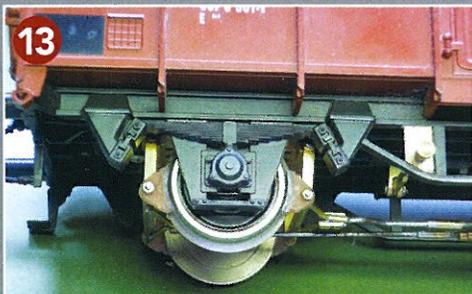
Bremsgestänge und Stellknopf an der Achse signalisieren schon, dass hier die Räder tatsächlich mittels der Bremsbacken gebremst werden können.
