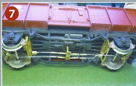
4 Der seitlich von unten auf den Unterboden fallende Blick offenbart die Anordnung der Bremsanlage mit den aus Dentalkunststoff gefertigten Bremsbacken.
