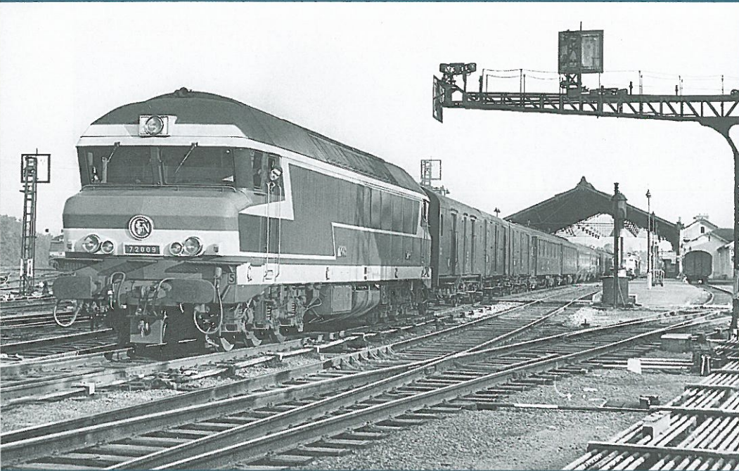
Der Express „Ocean-Lyon“ (Quimper und Nantes – Lyon) verlässt den Bahnhof Saint-Germain-des-Fosses am 2. Juni 1970. Die CC 72009 hat mehr als 600 Tonnen am Zughaken.
