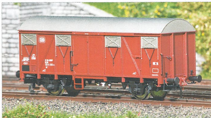
Das Epoche-IV-Modell: Bremsschläuche und eine Kupplungsattrappe liegen zum Nachrüsten der Packung bei.
