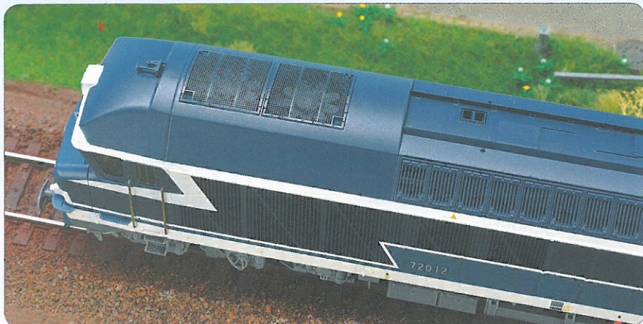
Bei der Betrachtung von oben stechen sofort die ultra-feinen Abdeckgitter für die beiden Ventilatoren ins Auge. Bei der angekündigten FRET-Version werden diese sich drehend zu bewundern sein.
