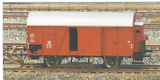
Gedeckter Güterwagen der DB: Das Fahrzeug der Bauart Gr 20 verfügt über ein Bremserhaus und bewegliche Schiebetüren.
