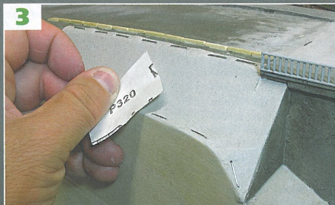
Einer jener Vorteile dieser Technik gegenüber der alten mit Fliegendrahtgitter: Dank Verschleifens erscheint die Segmentkante absolut perfekt!
