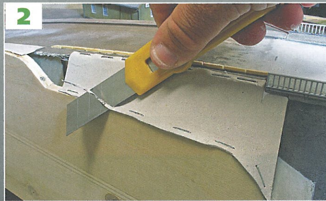
Fest verleimt und getackert: Im Zuge der Entfernung überstehenden Materials ist darauf zu achten, das weiche Sperrholz nicht zu beschädigen.
