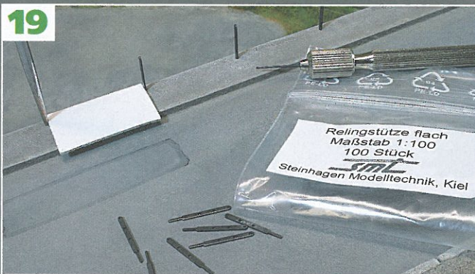
Jene Reling- oder Geländerstützen ( www.steinhagen-modelltechnik.de ) werden gesetzt: Abstandslehre, Reißnadel und Bohrer sind unabdingbar.
