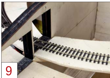
9 Die Gleise über den Segmentkanten wurden auf Messingschrauben verlötet und erst anschließend durchgetrennt.
