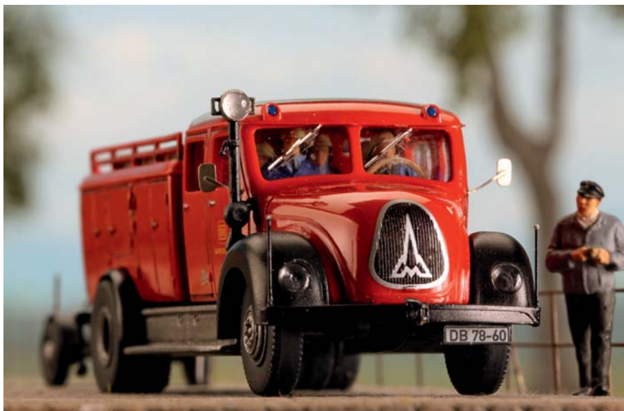
Neben dem Anbringen der Zurüstteile wird auch der Suchscheinwerfer farblich behandelt und mit einem „Scheinwerferglas“ aus UHU-plus verfeinert.
