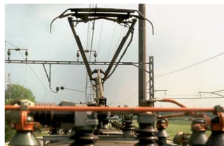
Der SBB-Stromabnehmer Bauart BBC-ESa 06 ist eine der wenigen Ausführungen von Einholmbügel, bei denen die Kuppelstange drückend über dem Unterholm liegt (Blick aus Kanzel des FL-Messwagens, 1982).
