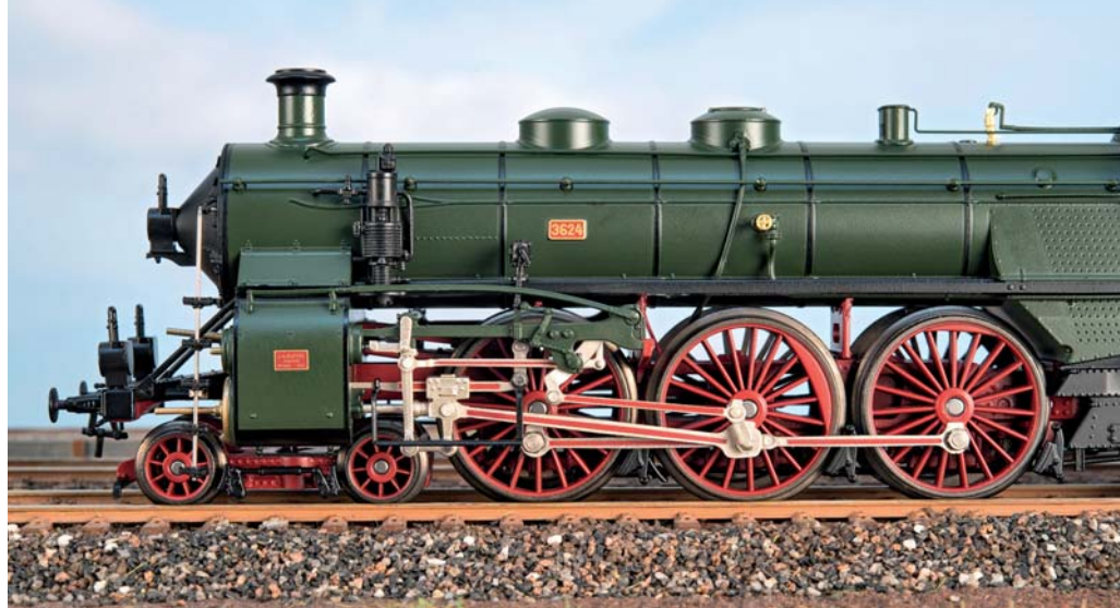
Soweit möglich, wurde der Barrenrahmen der Maschine durchbrochen dargestellt. Nur der Antrieb und der Modellrahmen hinter den Zylindern verhindern Durchblicke. Das Innentriebwerk wurde nicht nachgebildet.
