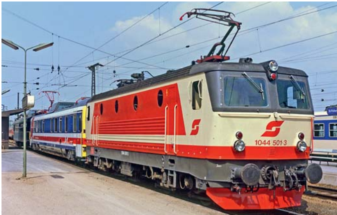
Die Schnellfahrlok 1044.501 und der Neubau-Messwagen trugen 1992 WBL 85-Stromabnehmer mit Luftfederbalg-Hubantrieb und einzeln gefederten Schleifleisten.
