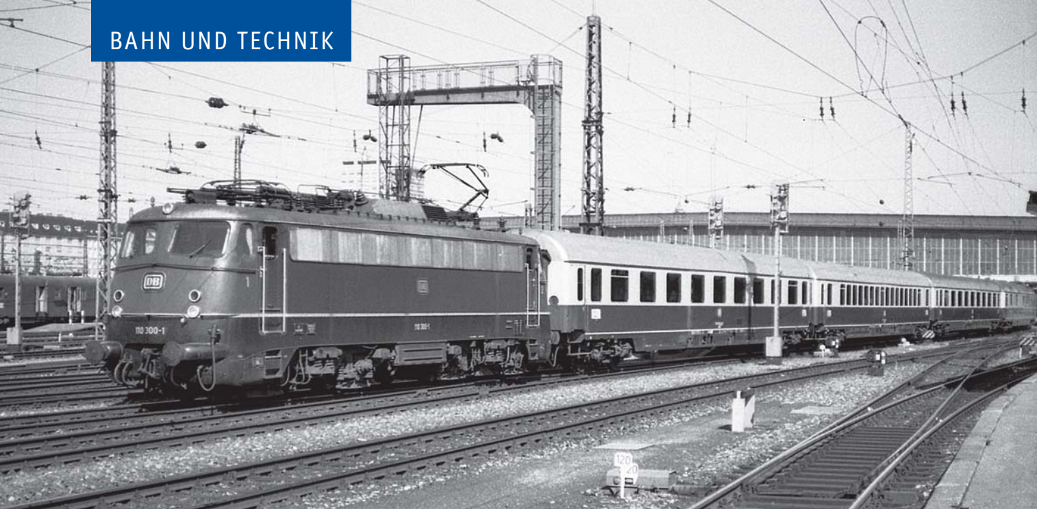
Die Erprobung von Einholm-Stromabnehmern begann bei der DB 1964 auf E 10 299 und 300 mit 200 km/h-Fahrten zwischen Bamberg und Forchheim (110 300 mit Siemens-SBS 65 in München Hbf 1971).
