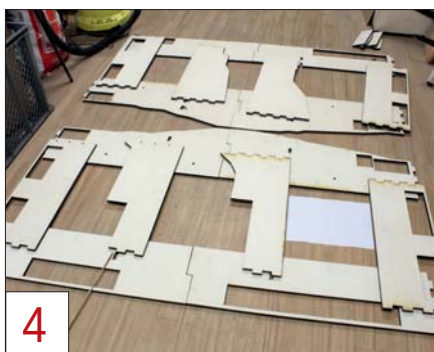
4 Das Rahmenpuzzle: Alle 16 gelaserten Bauteile ließen sich passgenau zusammenfügen und ersparten viel Schreinerarbeit.
