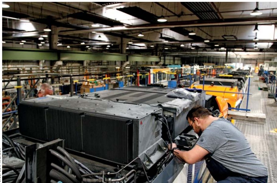
Einen bedeutenden Teil des Umsatzes erbringen fristgemäße Untersuchungen an Straßenbahnfahrzeugen. Hier wird vor dem Abschluss der Arbeiten die Dachrüstung komplettiert.
