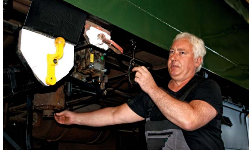
Ralf Janicki war einst im Raw noch am Bau der BmH-Wagen beteiligt. Nun legte er erneut Hand an, um die Bremsanlage zu komplettieren.
