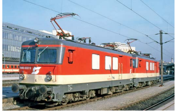
Die Zweisystemloks 1146.002 und 001 setzen sich zur Fahrt nach Budapest 1988 mit angehobenem Stromabnehmer Bauart VI mit ÖBB-Palette in Wien Ost vor den EC „Lehar“. Auf den hinteren Positionen war eine 2060 Millimeter breite Palette nach MAV-Norm montiert.
