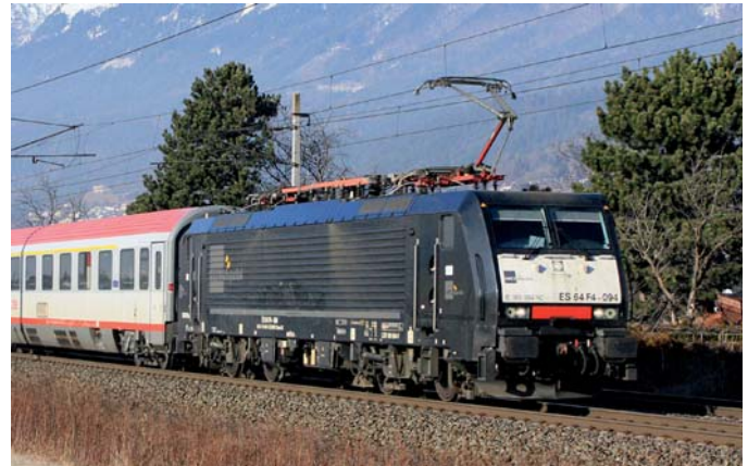
Auf den Mehrsystemloks ES 64 F4 befinden sich vier SBS 2T, deren Paletten je nach Einsatzgebiet/System mit unterschiedlichen Kontaktmaterialien, Dimensionen und unterschiedlichem Anpressdruck arbeiten.
