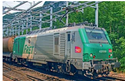
Prima BB37000 der SNCF mit Faiveley-Einholm AX unter starrer Stromschienen-Oberleitung am 27. Juli 2017 in der Abzweigstelle Longeraie (Strecke Genf-Bellegarde, 2014 umgestellt von DC auf 25 kVAC).
