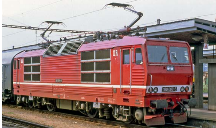
Die Škoda-Zweissystemlok DR-180 (280) trug so wie die ČSD-Loks für 3 kVDC/ 25 kVAC Stromabnehmer mit vier Schleifleisten, die für beide Systeme gleichermaßen benutzt wurden. Beim Einholm-LSP 12 läuft die Kuppelstange für die Oberschere innen im Unterholm (Prag, 2. Mai 1992).
