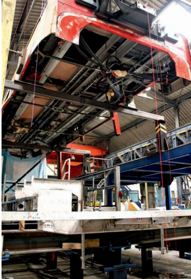
Bei der Ausbesserung von schweren Unfallschäden werden Fahrzeugkarosserieteile oft mit neuen Strukturen ersetzt.
