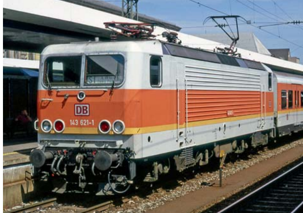
Die Stromabnehmer LEW-VHS2 auf der 143 entsprachen mit Kolbenantrieb auf Hochspannungspotential und sonstiger Auslegung, abgesehen von der Stützbasis, in etwa dem Typ SBS81 der DB.
