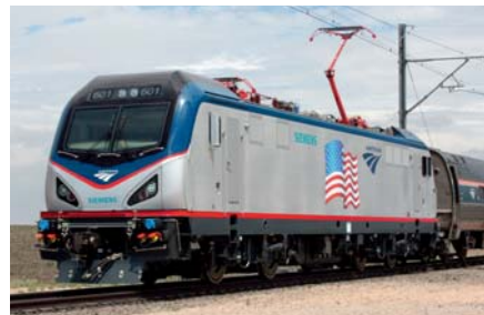
Siemens-Lok mit Fremd-Stromabnehmer: ACS 64 (Vectron Amerika-Version) im Juli 2013; der hochreichende Einholm für den US-Nordost-Korridor ohne Kuppelstrebe (mit Kettenradantrieb im Kniegelenk) stammt vom britischen Hersteller Brecknell-Willis.
