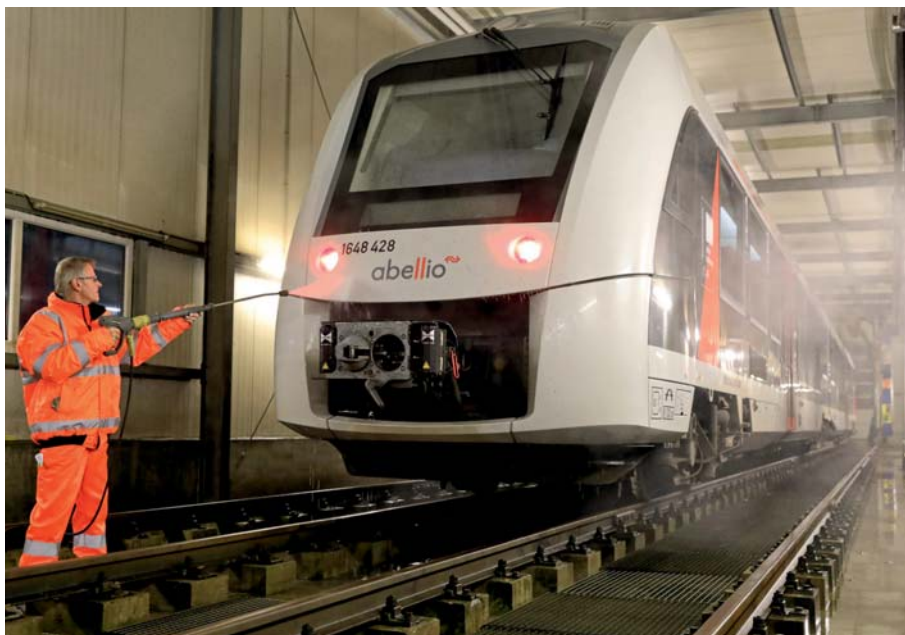
Analog zu Autowaschanlagen wird in der Waschstraße der VIS erst manuell vorgereinigt. Rotierende Bürsten übernehmen anschließend die Hauptarbeit.
