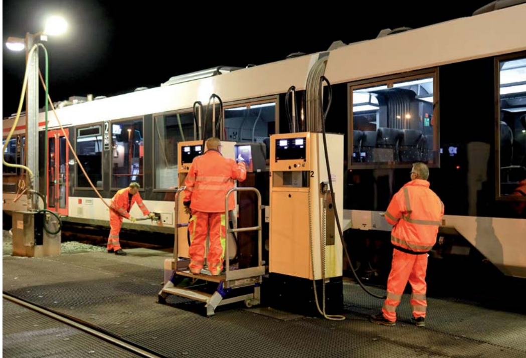
Das Entleeren des Abwasserbehälters und das Betanken können gleichzeitig geschehen. Für das Betanken der Abellio-LINT mit AdBlue wurde 2018 eine neue Tankstelle errichtet.
