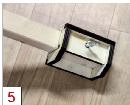
5 Auch die acht Beinhaltungen, die in den Rahmenecken platziert wurden, entstanden aus gelasertem Pappelsper Holz.
