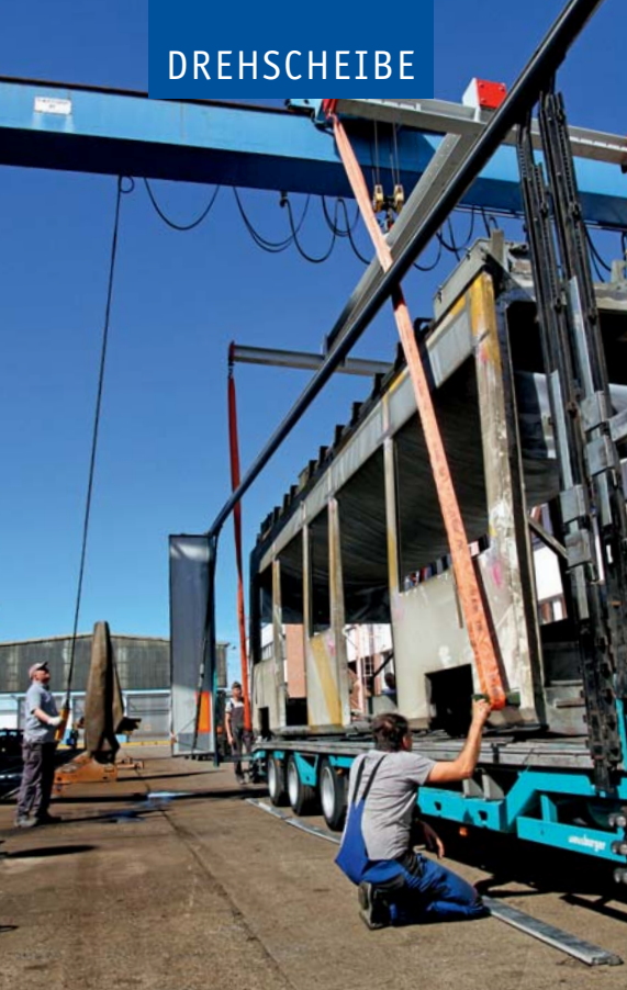
Mit einem Portalkran werden per Tieflader transportierte Wagenkästen verladen.
