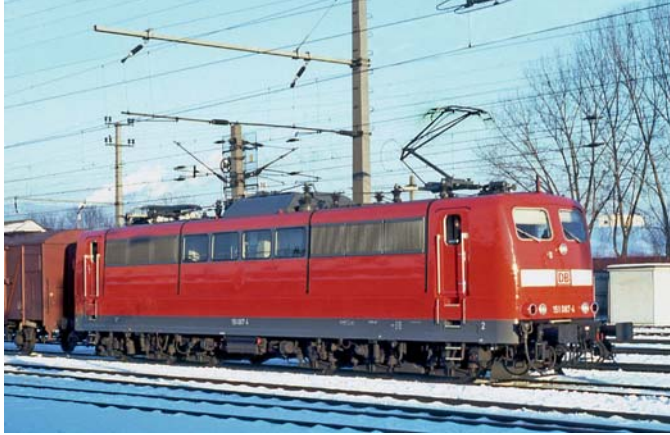
Einholm-Stromabnehmer SBS 65 auf 151087 in Linz Hbf im Januar 2000. Im Gegensatz zum DBS 54 und ÖBB VI läuft bei dieser DB-Wippe jedes Schleifstück der in sich starren Palette in ein eigenes Auflaufhorn aus. Die Bauform wird scherzhaft auch als „Rechen“ bezeichnet.
