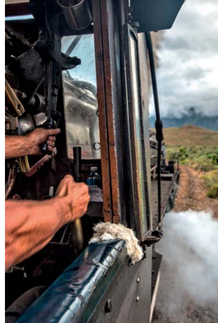
Die rechte Hand am Sandstreuer, die linke am Regler: So bezwingt man Steigungen.
