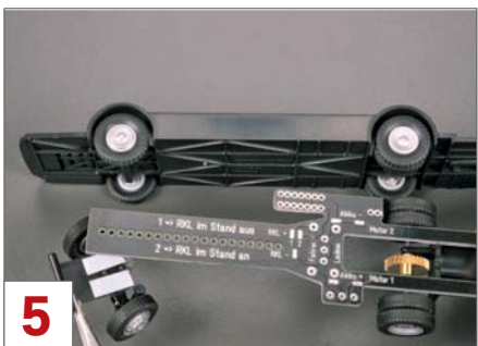
5 Die Befestigung des Motorträgers und der Vorderachse erfolgt vorsichtshalber zunächst mit doppelseitigem Klebeband.
