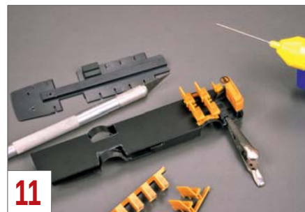
11 Von der ursprünglichen Deckplatte mit den einzelnen Sitzreihen bleibt nur der vorderste Teil erhalten.
