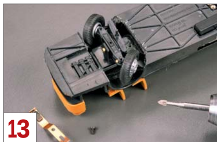
13 Nach dem Trocknen ist das Fahrgestell ausreichend stabil, so dass sich nun ein Freiraum für die Vorderräder schaffen lässt.
