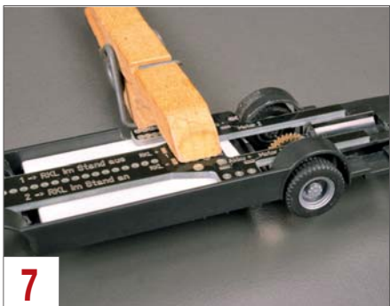
7 Die Höhe der Achsen wird mit einer extra eingeklebten, drei Millimeter starken Unterlage eingestellt.
