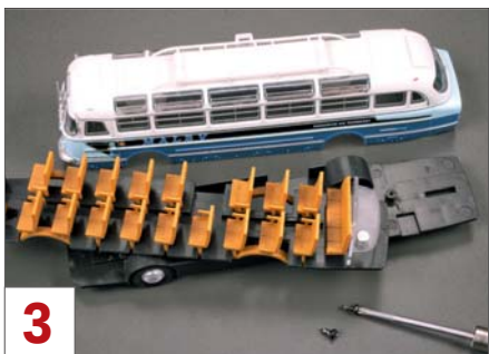
3 Die Karosserie des Fahrzeugs lässt sich nach oben abziehen, die Deckplatte mit den Sitzen ist verschraubt.
