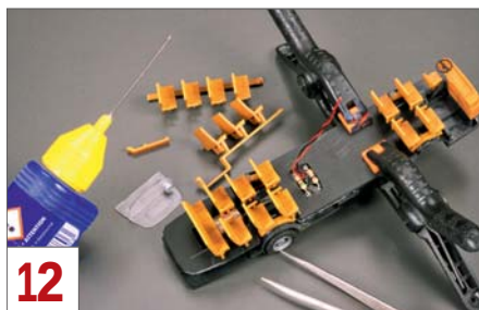
12 Mit einem Kunststoffkleber wie Revell-Contacta werden die neue Platte und die hinteren Sitze montiert.
