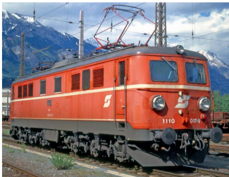
1110017 mit Wa7-Palette: In den 60er-jahren bevorzugten die ÖBB die Wanisch-Palette mit einzeln montierten Schleifstücken.
