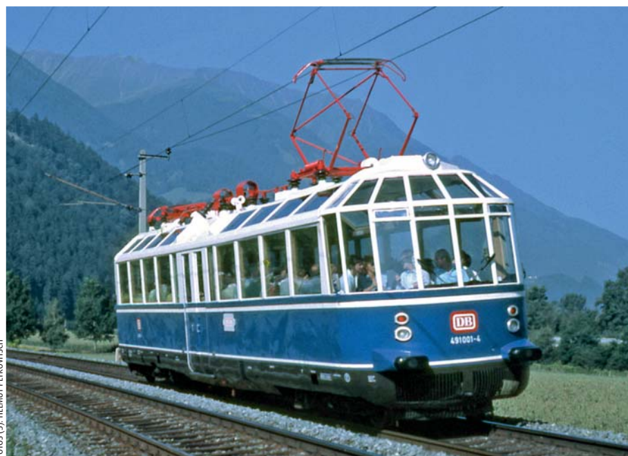
Der Gläserne Zug 491001 trug ab 1976 einen DBS 54 für DB/ÖBB und einen Einholm-SBS 65, der bei Bedarf mit einer SBB-Palette bestückt werden konnte (Zirl, September 1986).
