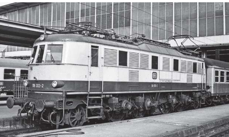
118013 in München Hbf im Jahr 1976, nachgerüstet mit Stromabnehmern des Typs SBS 39 mit Doppelschleifstück-Palette DBS 54.
