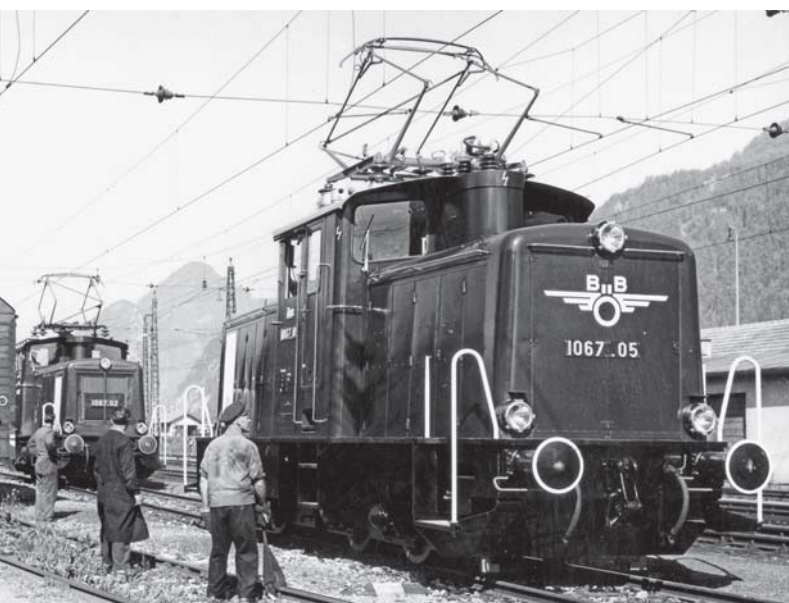
Stromabnehmer der ÖBB-Bauart V auf elektrohydraulischen Verschlussloks der Reihe 1067 in Jenbach am 9. Juni 1964.
