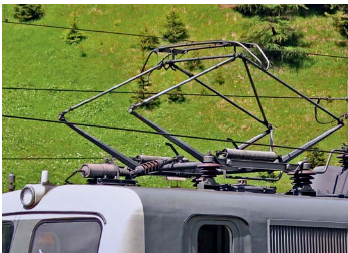
Detailaufnahme eines nun in Grau statt nach DB-Norm in Feuerrot gehaltenen Stromabnehmers der Bauart DBS 54 auf der 2011 an Railadventure verkauften 139558 (25. Mai 2018).
