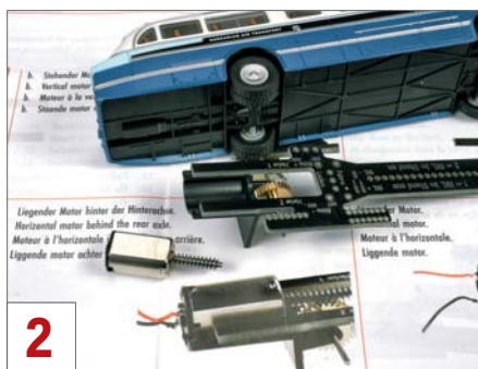
2 Fast wie beim Vorbild kommt für den Brekina-Bus die Variante „liegender Motor hinter der Hinterachse“ infrage.
