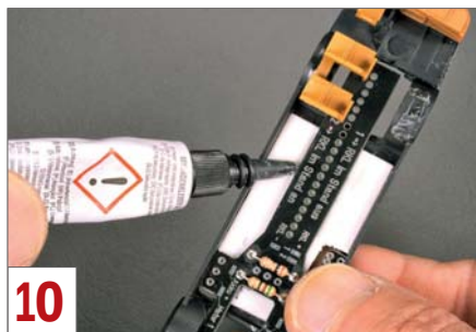
10 Wenn der Testlauf zufriedenstellend ausfällt, kann das Car-System-Fahrgestell dauerhaft verklebt werden.
