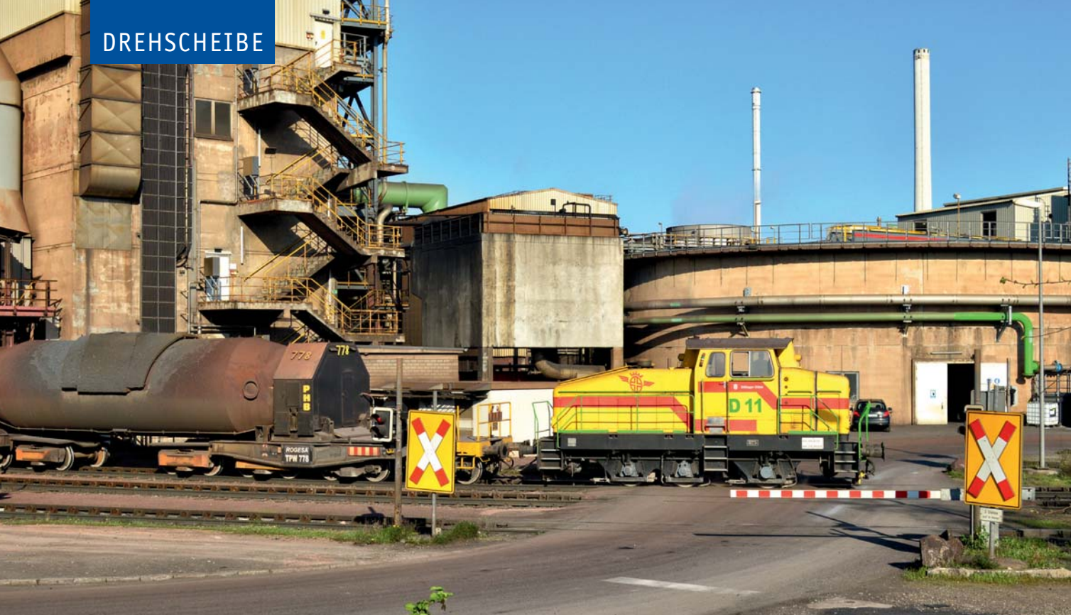
Lok D 11 (Henschel, 1967) der Dillinger Hütte zieht einen 16-achsigen Torpedowagen mit flüssigem Roheisen vom Hochofen in den Werksbahnhof.
