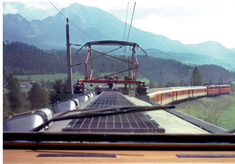
Stromabnehmer der Bauart ÖBB-V mit Wanisch-Palette als Messbügel auf dem Elektrotechnischen Messwagen 950.100.
