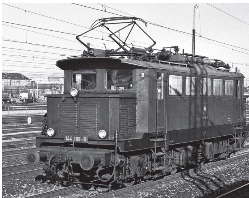
DBS 54 auf Altbaulok: Die 1965 auf 15 kV/16 2/3 Hz umgebaute Höllental-E244 11 bestückte man mit Neubau-Stromabnehmern. Erstausrüstung auf der E244 für 200-mm-Zickzack war ein auf 1300 Millimeter Scherenbreite reduzierter HISE-Stromabnehmer.
