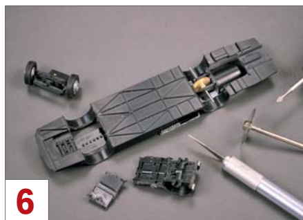
6 Die größte Herausforderung beim Einbau des Fahrgestells sind sicher die notwendigen Änderungen an der Bodenplatte.
