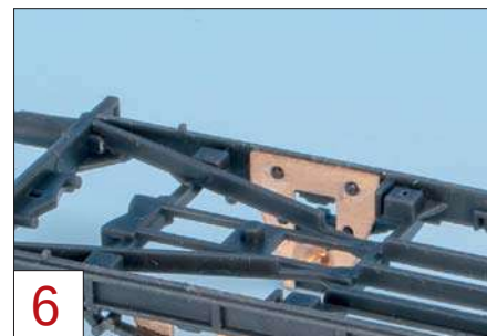
6 Durch Ansenken der Löcher im Achshalter verbessert sich die Festigkeit nach dem Verkleben.
