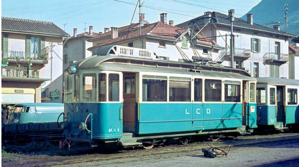
BFe2/3 Nr. 3 im Depot La Santa. Die vier ursprünglich zweiachsigen Triebwagen erhielten in den 1940er-Jahren dreiachsige Lenkachs-Fahrwerke mit mittiger Laufachse.
