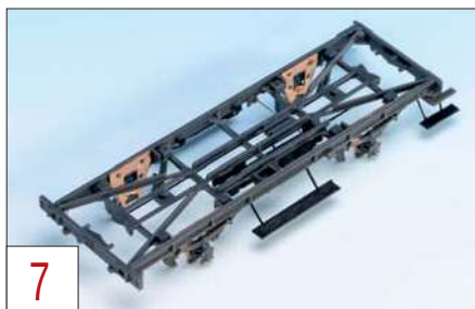
7 Zierlich, aber dennoch bruchsicher sind die Tritte unter den seitlichen Schiebetüren sowie für den Aufstieg zum Bremserhaus.
