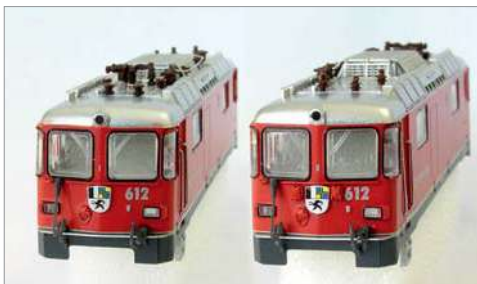
Die RhB-„Bobo“ mit Vielfachsteuerungsdosen.
