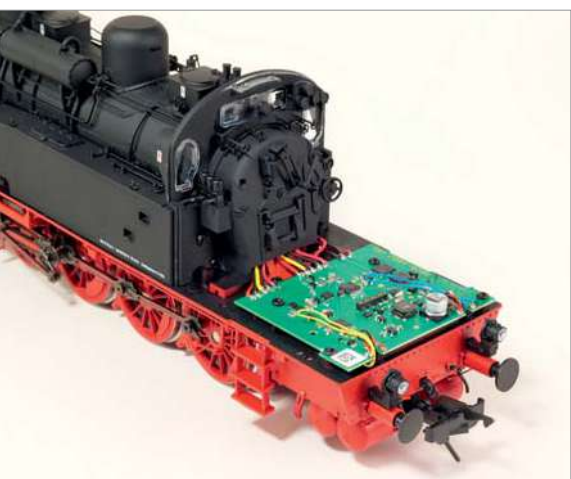
Ein Teil der Elektronik ist unter dem Fußboden verstaut und stört nicht den Blick in den eingerichteten Führerstand.
