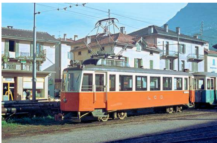
BFe2/3 Nr. 3 im Depot La Santa. Die vier ursprünglich zweiachsigen Triebwagen erhielten in den 1940er-Jahren dreiachsige Lenkachs-Fahrwerke mit mittiger Laufachse.
