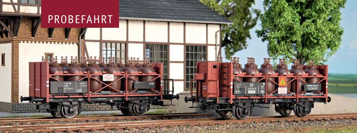
Die Säuretopfwagen gibt es in vielen Varianten mit Bremserhaus (rechts, DB), aber auch ohne (links, DR).
