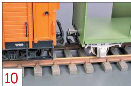
10 Eine Probe mit einem Serienfahrzeug zeigt, ob die Kupplung in der richtigen Höhe montiert ist.
