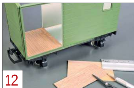
12 Aus dünnen Furnierholzstreifen, in die der Bastler die Bretterstruktur einritzt, entsteht der Boden für den Innenraum.
