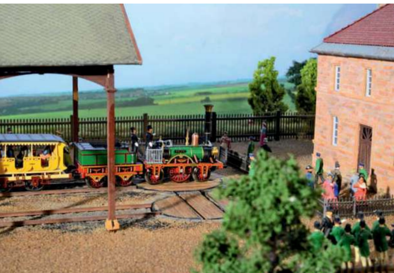
Ankunft in Fürth: Der Zug muss nun für die Rückfahrt gedreht werden. Dazu schiebt man als Erstes die Lok, dann den Tender sowie die Wagen auf die Drehscheiben. Beide Drehscheiben lassen sich mittels eines Rundriemens und Drehgriffen vom Anlagenrand aus bewegen.
