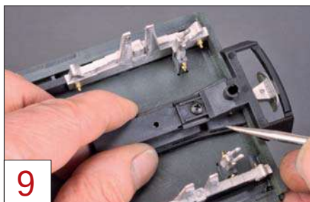
9 Die Aufnahme für die Trichterkupplung wird am Wagenboden verklebt, die LGB-Kupplung ist verschraubt.
