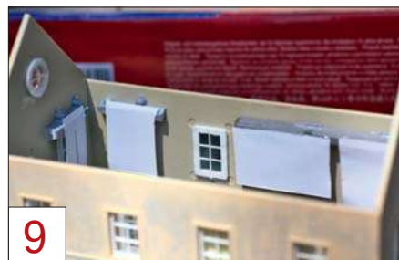
9 Die Gardinen-Attrappen aus Papier werden an Spritzlingsresten aufgeklebt, damit etwas Abstand zum Fenster entsteht.
