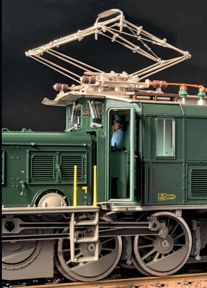
Die Fülle an Details ist groß: Türen zum Öffnen, feine, motorisch hebbare und senkbare Stromabnehmer, Bremsen mit farblich abgesetzten Klötzen und geätzte Lochbleche über den Führerstandsfenstern.
