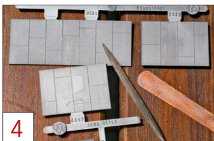
4 Die von Piko angedeuteten Reparaturstellen am Vordach werden abgeschabt, weil sie zu grob erscheinen.
