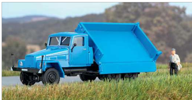
Die Ladefläche des G5 kann auch in Schräglage fixiert werden.
