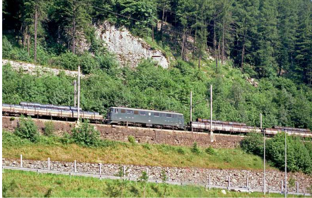
„Eingewickelte“ Ae 6/6 als Zwischentriebfahrzeug in einem Ganzzug mit Ölfeldrohren am Gotthard knapp vor dem Kulminationspunkt in Göschenen.
