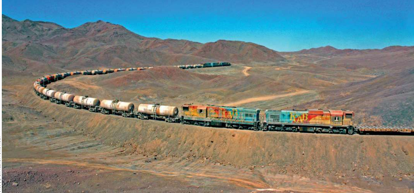
Einmal drei und einmal zwei EMD-Sechssachsloks verschiedener Bauarten der FCAB (Ferrocaril de Antofagasta a Bolivia) bringen 2012 vereint einen Zug mit 22 Kesselwagen voll Schwefelsäure und weitere Anhängelast über den Cumbre-Pass in der chilenischen Atacama-Wüste.
