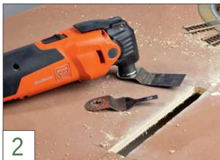
2 Mit dem „Multimaster“ von Fein lässt sich die rechteckige Öffnung für die Grube sehr gut aussägen.
