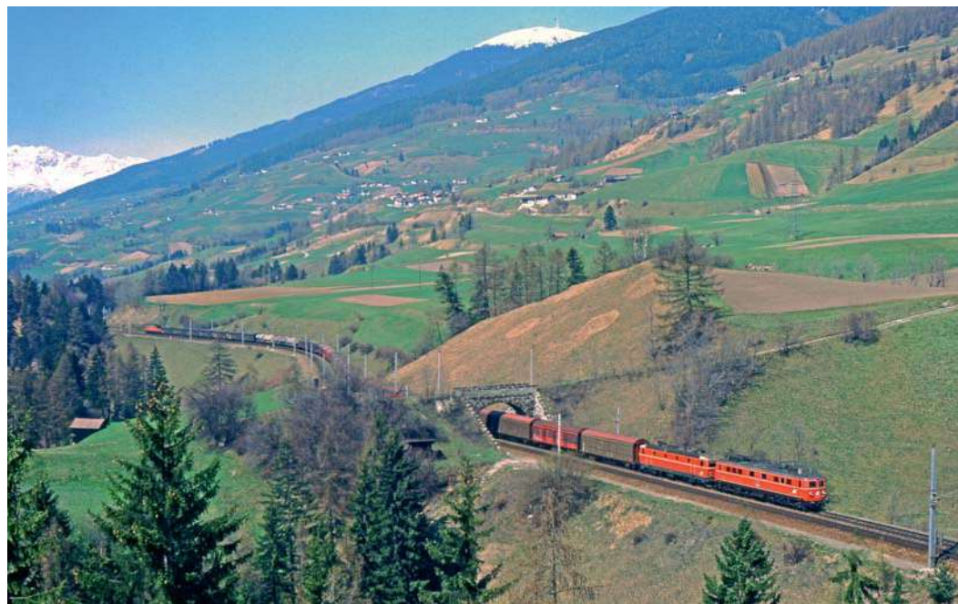
Matrei am Brenner am 29. März 1985: Schiebelokbetrieb bei einem 1500-t-Zug zum Brenner: 1110.5 und 1044 an der Spitze übernehmen 1010 Tonnen Zuglastanteil, den Rest (490 Tonnen) bewältigt die Schiebelok der Reihe 1020.
