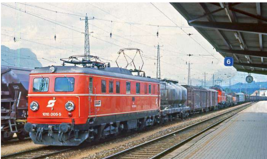
Zwischenlok auf der Giselaabahn (Saalfelden – Wörgl) im Jahr 1987: Überstieg das Anhängewicht die für die Strecke normierte Zughakengrenzlast auch nur geringfügig, wurde die Überlast vor der zweiten Lok eingereiht.
