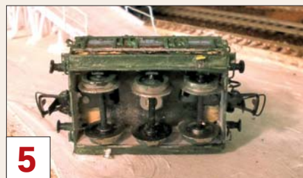
5 Die Kupplungen werden mit zwei Nägeln im Holzkörper befestigt.
