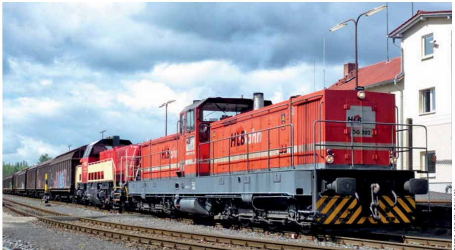
Die DG202 ist das älteste Fahrzeug der HLB. Die 1959 gebaute Lok wurde 1986 bei Henschel grundlegend modernisiert. Kurzzeitig war die Voith Gravita als Ersatz für die alternde Lok im Gespräch, aus diesem Anlass fand am 14. Juni 2013 eine Probefahrt mit V181 der HZL statt.
