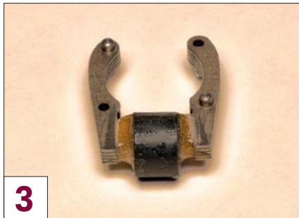
3 Der Leimauftrag für den Magneten war zu üppig. Er musste etwas befeilt werden, um einen korrekten Sitz zu gewährleisten.
