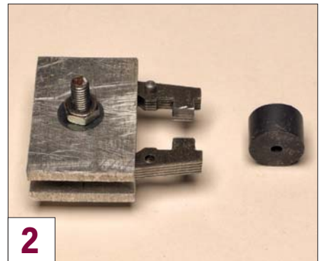
2 Das Blechpaket des Stators ist in seiner Lage gesichert und für den Magneten bereits passend durchtrennt.
