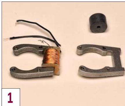
1 Links liegt die originale Feldspule, rechts sieht man eine ohne Wicklung sowie den vorgesehenen Permanentmagneten.
