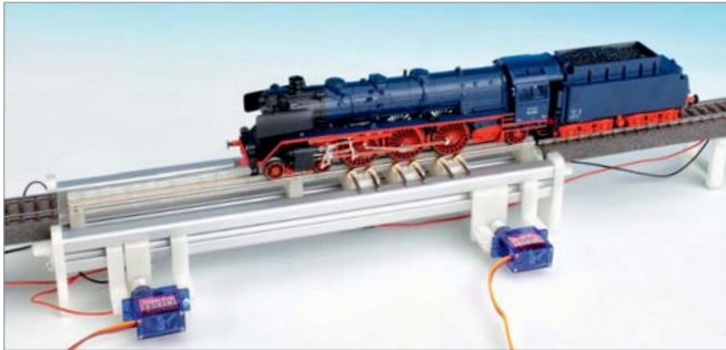
Der „Profi“-Rollenprüfstand von Zeller besteht aus Aluminium.
