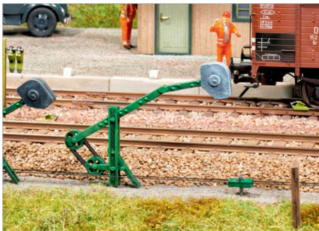
Das Signalspannwerk für die Spur 0 entstammt dem 3D-Drucker.
