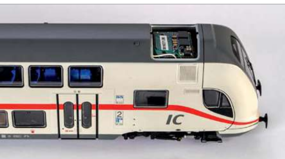
Der Decoder von Doehler & Haass befindet sich im Steuerwagen unter einer Abdeckung.
