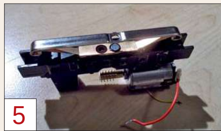
5 Nach den Fräs-, Bohr- und Feilarbeiten streicht man das Fahrwerk mattschwarz.
