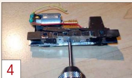
4 Nun werden die Bohrungen für das Kabel und die M2-Befestigungsschraube gesetzt.
