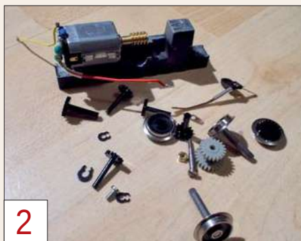
2 Für einen System-Umbau wird auch das Fahrwerk in seine Bestandteile zerlegt.
