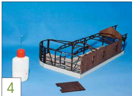
4 Nun folgen die Außenwände an der Rückseite des Gebäudes. Sie sind aus lasergraviertem Naturholz gefertigt.
