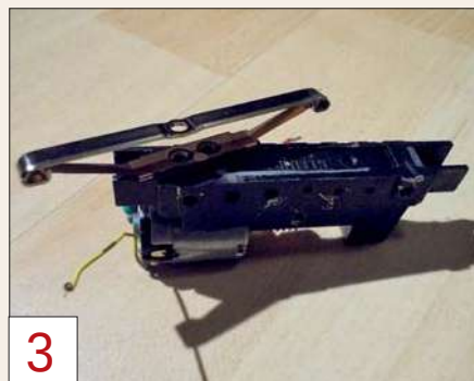
3 Dann markiert man den für den Schleifer benötigten Platz am Fahrwerksrahmen.
