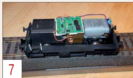
7 Vor dem Decodereinbau wird das Gewicht links ausgesägt und der Antrieb abgedeckt.
