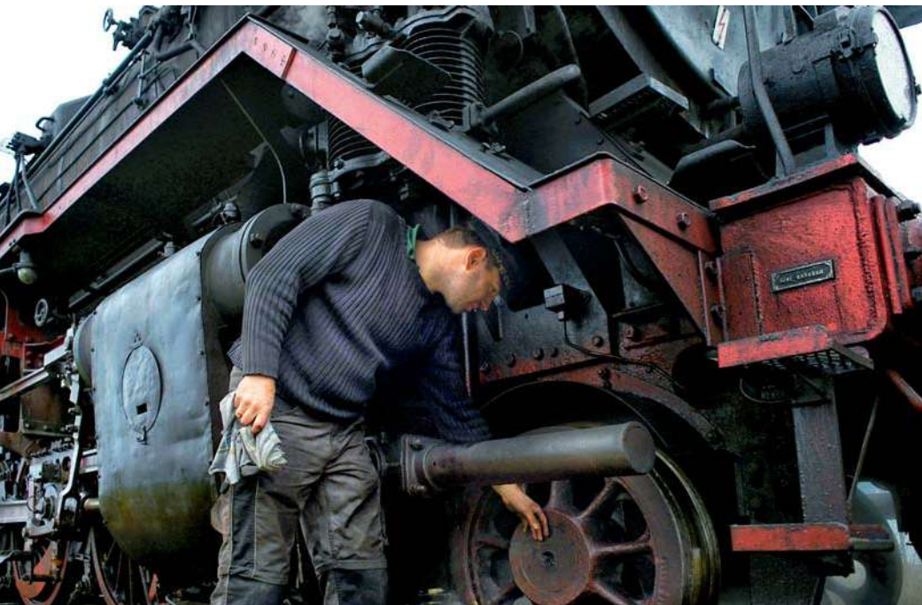
Betriebshalt und Abfühlen der Lagertemperatur der Vorlaufachse. Empfindlicher ist das hintere mittlere Treibstangenlager jeder 44, welches immer unter besonderer Beobachtung steht.
