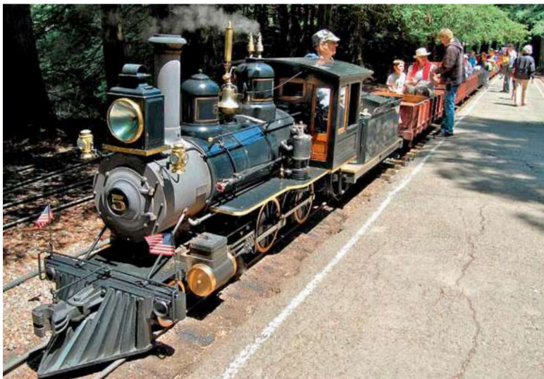
Die Dampflok von 1952 von einem Eisenbahningenieur gegründeten Redwood Valley Railway in Kalifornien fahren mit Ölfeuerung.
