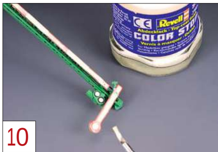
10 Kleine Details werden vor der Farbbehandlung mit einer Schicht Abdecklack maskiert.
