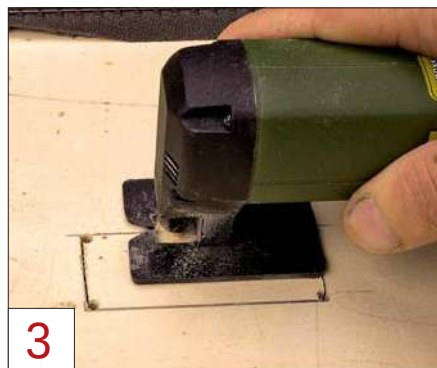
3 Nach dem Aufbohren der Ecken folgt ein Ausschnitt mit einer kleinen Stichsäge.
