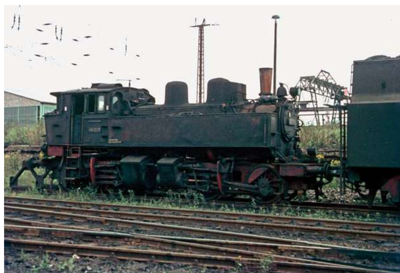
98 008 im selben Bw: Im Gegensatz zur IVK tragen Normalspur-Meyer-Loks ihre Hochdruckzylinder am vorderen Drehgestell.
