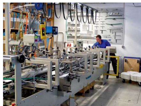
Für die Kartonagen- und Verpackungsherstellung ist auch eine zwölf Meter lange Faltschachtel-Klebmaschine in Aktion, die von Danny Hengst bedient wird. Modellbahnfirmen aus ganz Deutschland beziehen hier mittlerweile Schachteln. Beliebt sind auch die roten Auhagen-Aufbewahrungs-Boxen.
