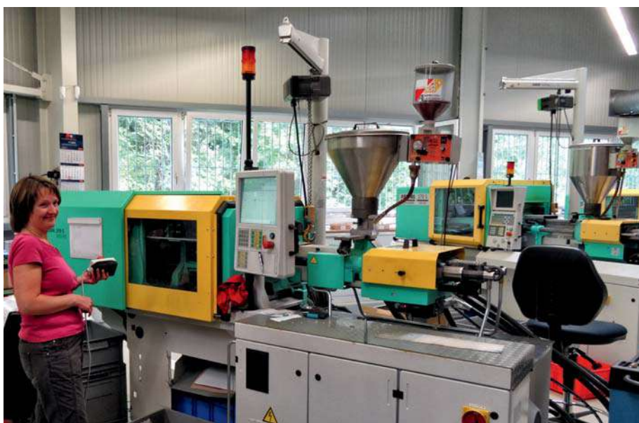
Die Kunststoff-Spritzmaschine ist Frauensache: Kathrin Fleischer steuert den Produktionsablauf, bei dem Kunststoff bei 230 Grad in die Form gespritzt und dann wieder abgekühlt in handwarmem Zustand als fertiges Bausatzteil ausgeworfen wird.
