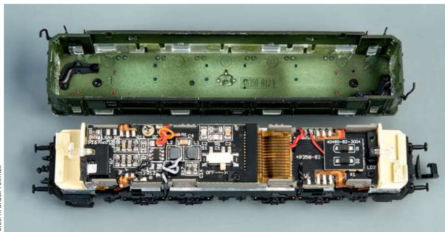
Die Elektronik-Bauteile wurden auf der geteilten Platine so kompakt angeordnet, dass die (digital beleuchtbaren) Führerstände frei bleiben konnten. Rechts liegt die Decoder-Schnittstelle.
