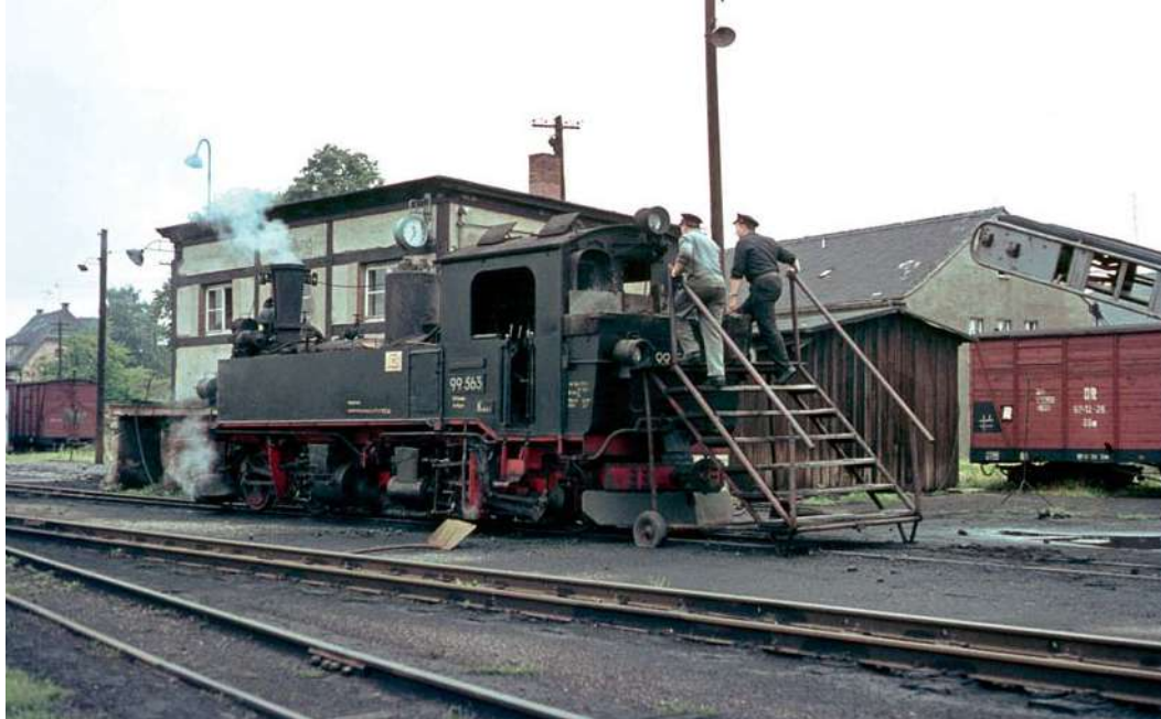
Beim Bekohlen von 99 625 in Mügeln: Die breite Treppe macht es möglich, dass zwei Mann nebeneinander den Aufstieg mit dem schweren Korb bewerkstelligen können. Bei der sä. IVK sind die kleinen Hochdruckzylinder im hinteren Drehgestell angeordnet.
