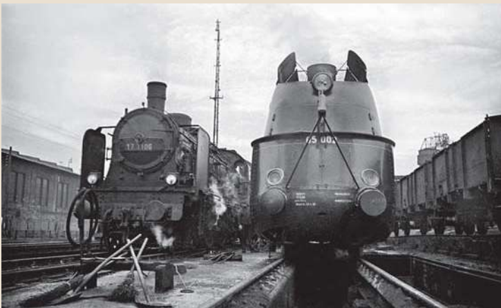
Für Versuchsfahrten im April 1936 trug 05 002 eine Windmesseinrichtung. Im Bw Hamburg-Altona begegnete ihr die S 101, 22 Jahre älter als die moderne Stromlinienlokomotive.
