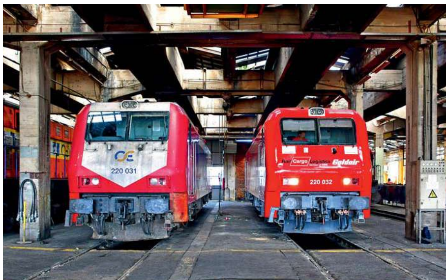
RCLG-220032 und OSE-220031: 36 Lokomotiven des Typs DE 2000, die bereits den Traxx-Look zeigen, wurden von 1997 bis 2004 von Adtranz/Bombardier nach Griechenland geliefert.
