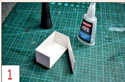
1 Fünf Kartonteile bilden die Basis des Wassertanks, sie werden stumpf verklebt.
