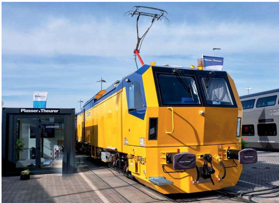
Auch Gleisbaumaschinen versuchen, den Diesel überflüssig zu machen: die vollelektrische Unit 09-4x45 E3 von Plasser & Theurer. Adieu, Dieselhydraulik.
