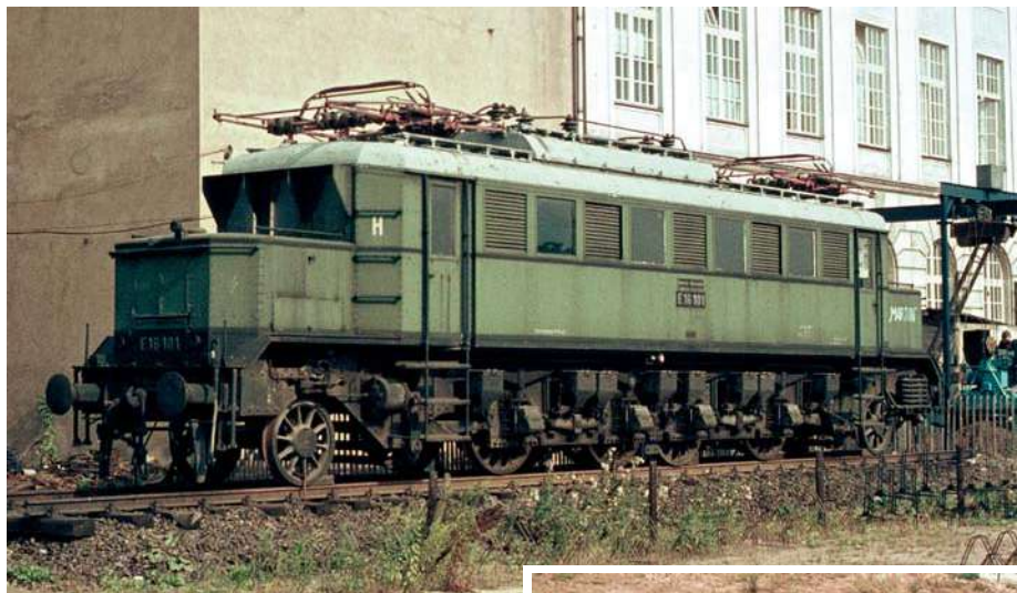
1'Do1'-Schnellzug-Versuchslok E 16 101 von Siemens mit vier Tatzlager-Motoren vor der HfV in Dresden am 17. August 1966. Wichtig zum Nachbau eines exakten Modells: der Blick auf das Dach.
