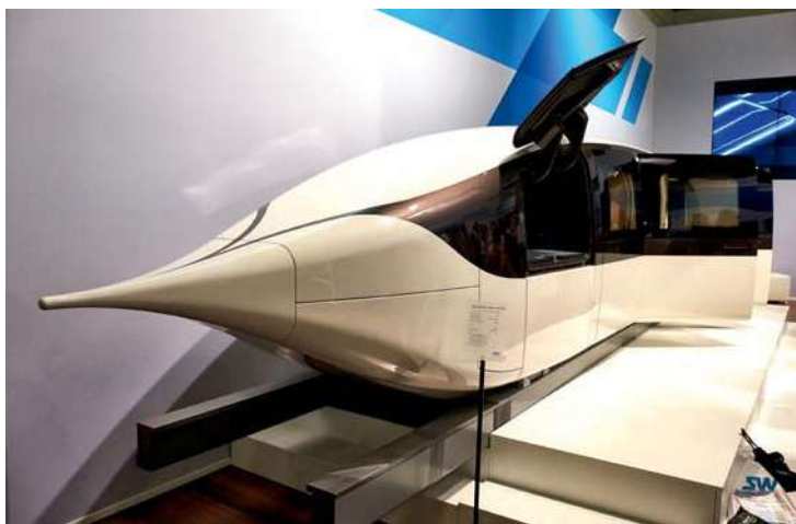
Die weißrussische Firma SkyWY zeigte ihren auf Stahlgleisen mit Drahtkern laufenden 500 km/h schnellen Unibus U4 mit einem cw-Wert von 0,06.
