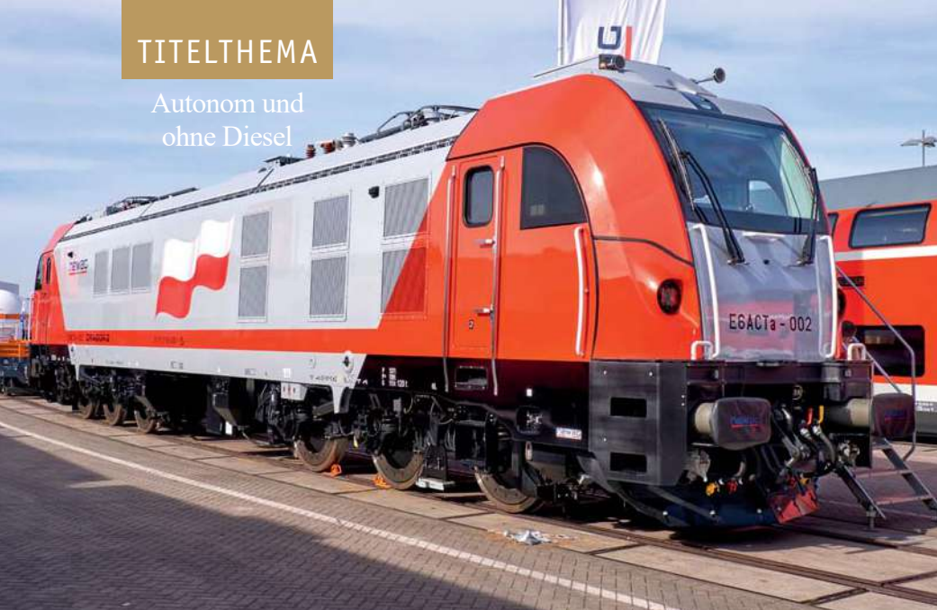
Newag stellte mit dem Dragon 2 eine Weiterentwicklung des bisherigen Fahrzeuges aus. Neu ist die Verwendung von Halbleitern aus Silizium-Carbid.
