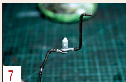
7 ... die Rohrleitung ebenso. Lötzinn erleichtert die Rohrführung um die Pumpe herum.
