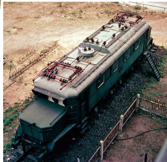
1'Do1'-Schnellzug-Versuchslok E 16 101 von Siemens mit vier Tatzlager-Motoren vor der HfV in Dresden am 17. August 1966. Wichtig zum Nachbau eines exakten Modells: der Blick auf das Dach.
