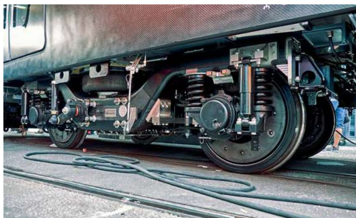
Gegenüber herkömmlichen Bauarten spart der CFK-Drehgestellrahmen beim Cetrovo von CRRC mehr als 40 Prozent Masse ein.
