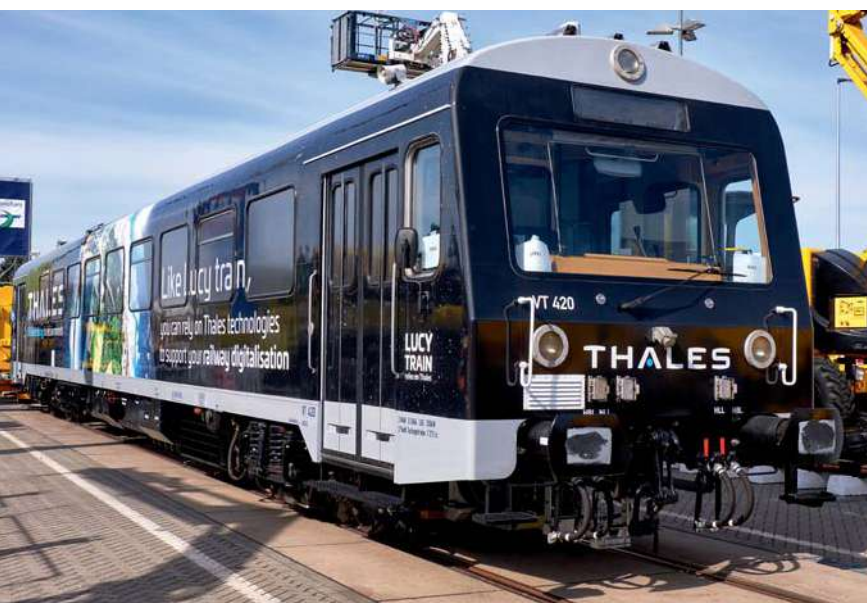
Der VT 420, ein umgebauter NE81-Triebwagen, dient dem Unternehmen Thales als Demonstrationsfahrzeug für autonomes Fahren.
