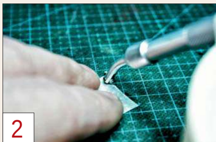
2 Die Außenverkleidung entsteht aus Malercrepp, in den man Nietreihen eingraviert.
