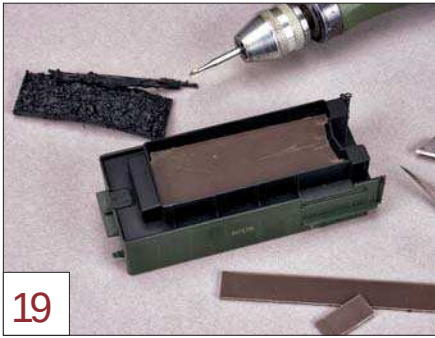
19 Mit einem Mini-Fräser ist die Kohle-Imitation aus Plastik schnell entfernt. Ein neuer Boden entsteht aus Kunststoff-Bastelplatten.
