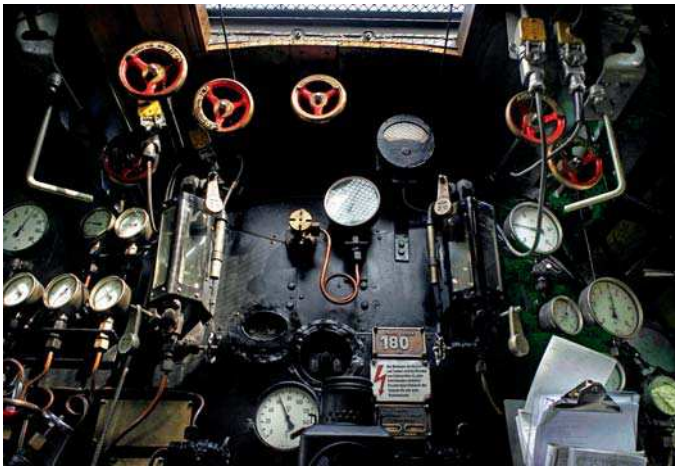
Der Kesseldruck am roten Strich (Bildmitte, 16 bar), 5 bar im Schieberkasten (rechts), die Steuerung liegt auf 33 Prozent, ...
