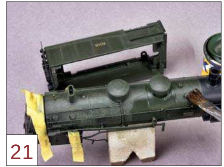
21 Das Gehäuse wird hauchdünn mit so genanntem Emaillelack besprüht. Für das Verwaschen sorgen Pinsel und Feuerzeugbenzin.
