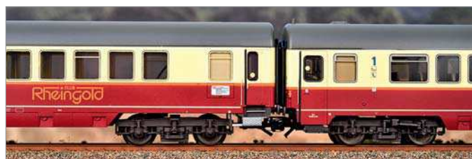
Die Wagen sind mit einer stromführenden Kupplung verbunden. Der spezielle Rheingold-Club-Wagen lief ab 1983 im DB-Paradezug.
