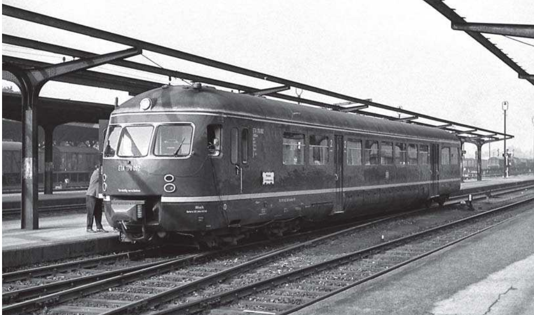
Limburg war für die Akkutriebwagen der Baureihe ETA 176, der späteren Baureihe 517, bekannt. 517 001 ist beim DB Museum in Lichtenfels bis heute erhalten und hinterstellt.
