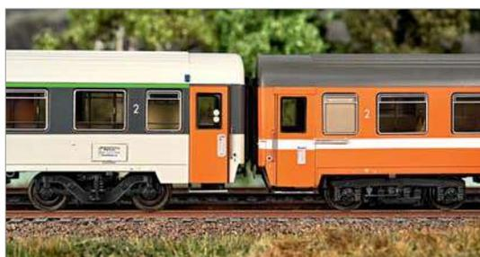
Der SNCF-Wagen läuft auf Y32-Drehgestellen, der Italiener auf solchen der Bauart Bredda.
