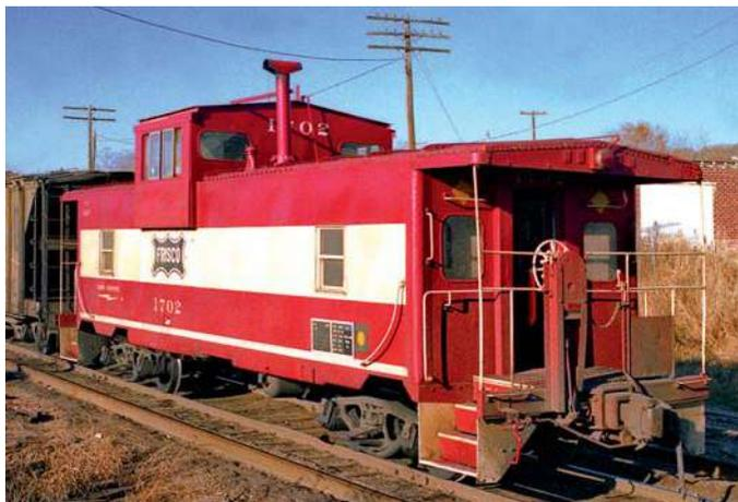
Standardbauform der neueren amerikanischen „extended-vision cabooses“: Nr. 1702 der „FRISCO“ mit Stahlkasten und Dachkanzel.
