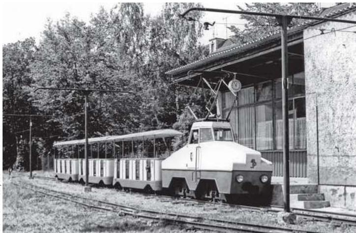
Seit 1959 existiert die Pionier-/Parkeisenbahn Plauen. Sie fährt mit 220 Volt Gleichstrom. Die im August 1978 abgelichtete Lokomotive entstand aus zwei Akku-Grubenloks der für die SDAG Wismut gefertigten Bauart Metallist.
