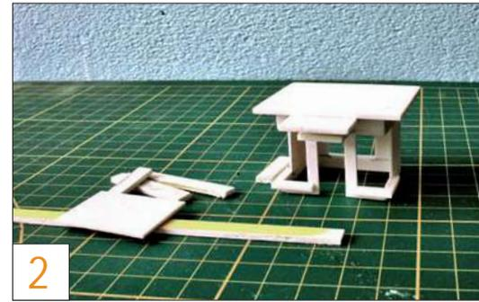
2 Diese bestehen aus Polystyrol-Platten unterschiedlicher Dicke. Sie wurden mit Plastikkleber verbunden.
