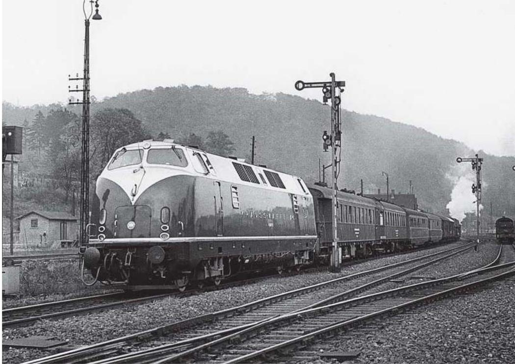
Die ML 2200 'C' mit Messzug und Bremslok bei einer Vorführfahrt für die Nato im Bahnhof Elm am 17. Oktober 1957. Die sechsachsige V200 entwickelte KM ursprünglich für Jugoslawien.
