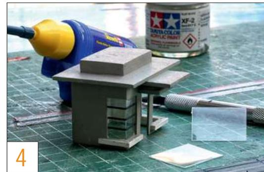
4 Die Fenstersprossen wurden aus Isolierband aufgeklebt. Auf dem Bild sind sie noch zu breit geraten.
