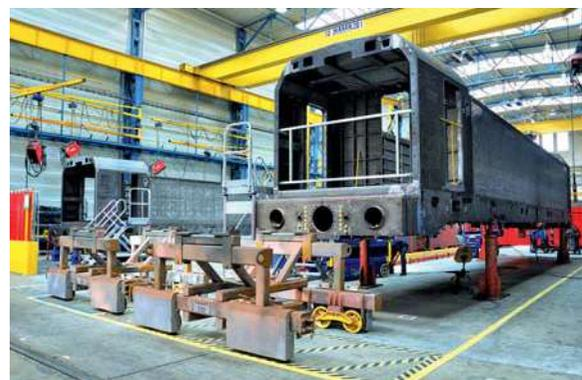
Vectron im Rohbau im Werk München-Allach: Das Bild unterstreicht auch die Fertigungstiefe bei Siemens.
