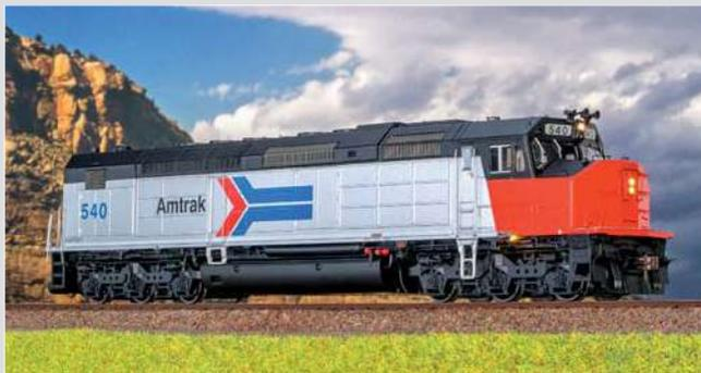
„Full-width cowl unit“, längerer Rahmen, Dampfkessel und großer Wassertank: So wird aus einer Güterzug- eine Personenzuglok.
