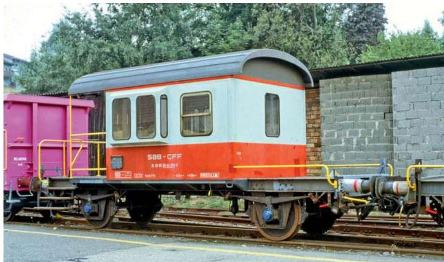
Im Swiss-Express-Lack wurden „Sputniks“ als Kuppelwagen für Verschub und Überstellung von Typ-III-Einheitswagen mit Mittelpufferkupplung verwendet (St. Fiden, September 1989).
