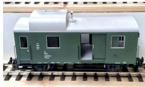
Der Pwg von Mathias Wüstner setzt sich aus 94 Einzelteilen zusammen, die alle auf dem Drucker (Nylon-Druck und PLA-Druck) entstanden sind.
