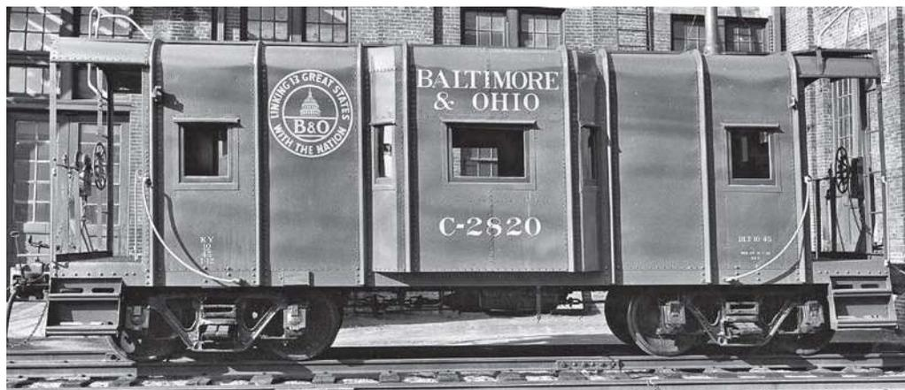
Eine „bay window-caboose“ der „Baltimore & Ohio“ in Stahlbauweise mit auskragendem Seitenerker zur Zugbeobachtung.
