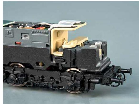
Sogar für eine Führerstandsachbildung fand sich Platz. Der Maschinenraum ist für eine (digital schaltbare) Beleuchtung vorbereitet.
