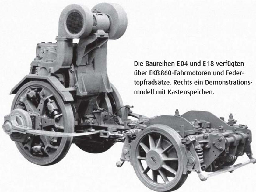
Die Baureihen E04 und E18 verfügten über EKB 860-Fahrmotoren und Federkopfadsätze. Rechts ein Demonstrationsmodell mit Kastenspeichen.
