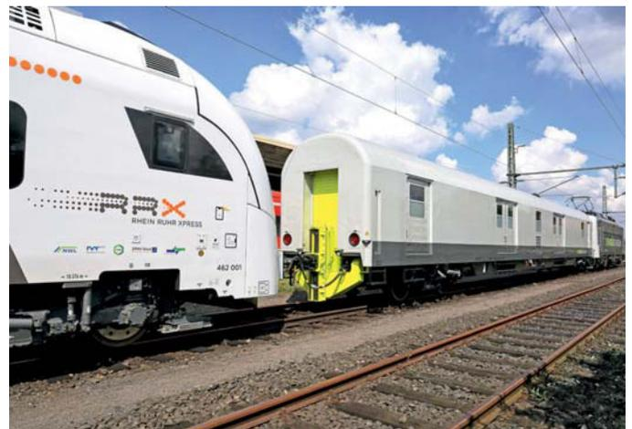
Die Kupplungsadapterwagen können mit verschiedenen Kupplungstypen in einer Höhe von 40 bis 160 Zentimetern ausgerüstet werden. So lassen sich sehr niedrige Kupplungsverbindungen zu Trambahnen oder sehr hohe zu einem Breitspur-Vectron auf „Loco Buggies“ herstellen.
