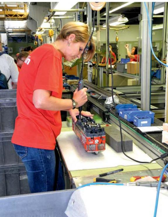
Das Werk in Győr ist die Heimat der LGB-Produktion. Gerade wird die Jubiläumsllok, deren Vorbild bei der RhB fährt, montiert.
