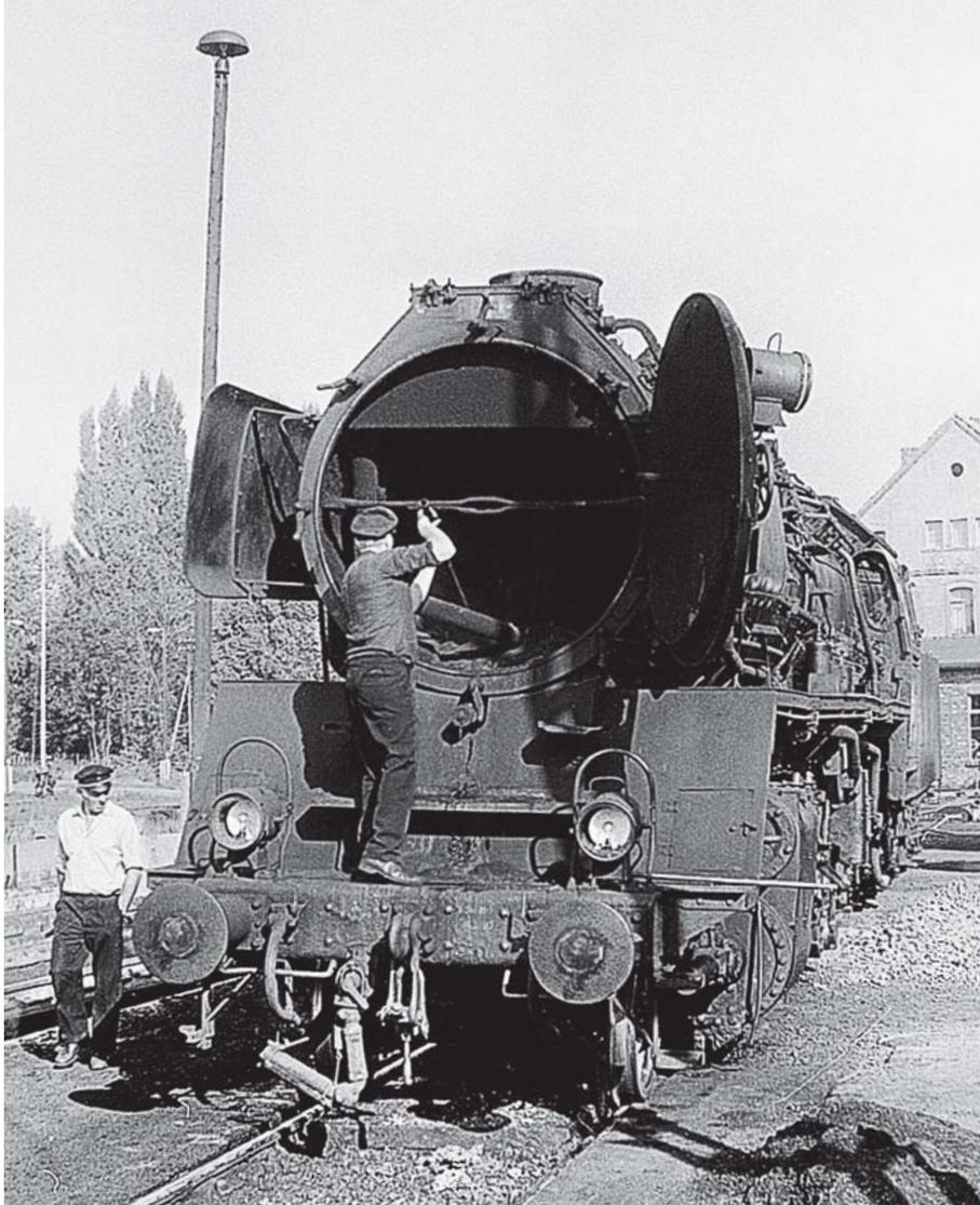
Anfang September 1988 reinigte der Heizer der 50 3606 die Rauchkammer seiner Maschine in Oschersleben. Wenige Tage später wurde die Dampflok durch 114 605 ersetzt.
