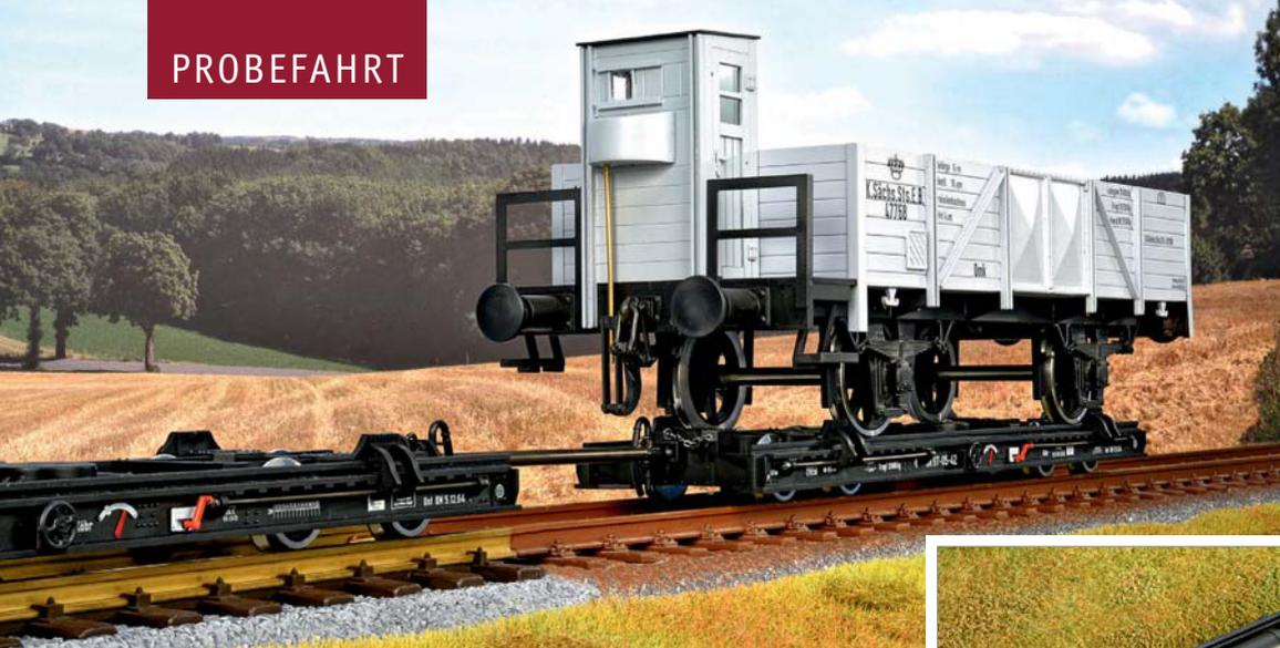
Der offene Spur-II-Wagen der K.Sächs.Sts.EB. von Strauß-Modellbahn sitzt perfekt auf den LGB-Wagen. Vom selben Hersteller sind auch Messing-Kuppelstangen verschiedener Länge erhältlich. LGB liefert jedoch drei Kuppelstangen pro Rollwagen-Set mit.
