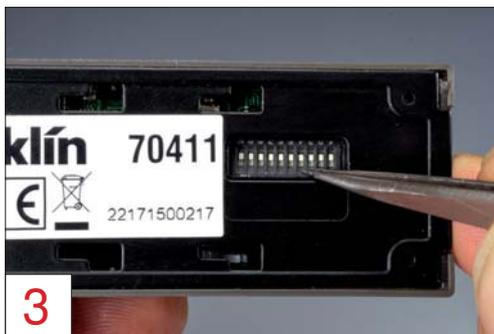
**3** Vor dem Einsatz müssen die Betriebsart und gegebenenfalls eine Adresse mit dem zehnpoligen DIP-Schalter an der Unterseite eingestellt werden.
