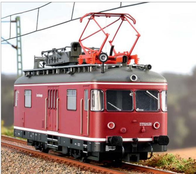
Abfahrt! Das Bühnengeländer ist eingeklappt, der Zugschluss eingeschaltet, jetzt muss nur noch der Stromabnehmer gesenkt werden.
