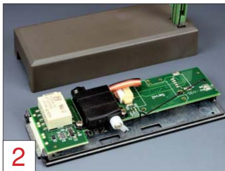
**2** Unter der Abdeckung sitzt die elektronische Steuerung. Der für die Bewegung zuständige Servo-Antrieb ist gut zu erkennen.
