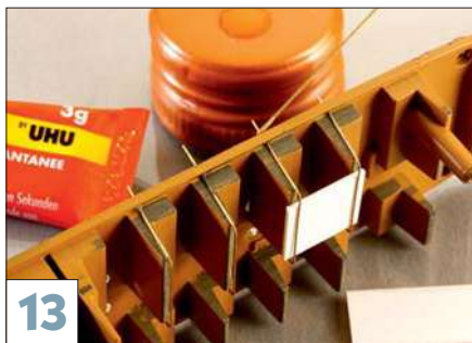
13 Ein 0,8 Millimeter starker Polystyrolstreifen dient als exakter Abstandshalter während des Verklebens der Bügel.
