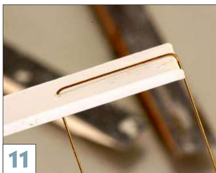
11 Eine einfache Biegeschablone aus abgerundetem Polystyrol dient zum Abwinkeln des anderen Endes der Haltestange.
