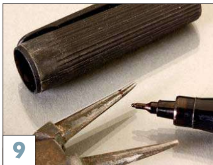
9 Mit einem Filzstift wird an den Schenkeln einer kleinen Rundzange der richtige Radius der Rundung markiert.
