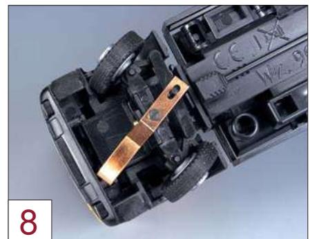
8 Nun werden die Aussparungen an den Vorderrädern dem Lenk-Ausschlag angepasst.
