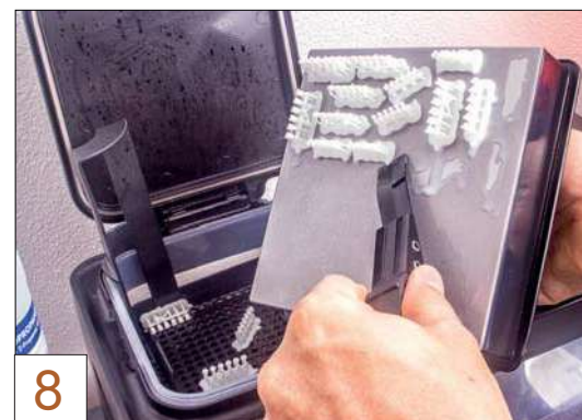
8 ... lassen sich die Drucke von der Plattform lösen und landen mit etwas Übung auf dem Sieb des Waschtanks.
