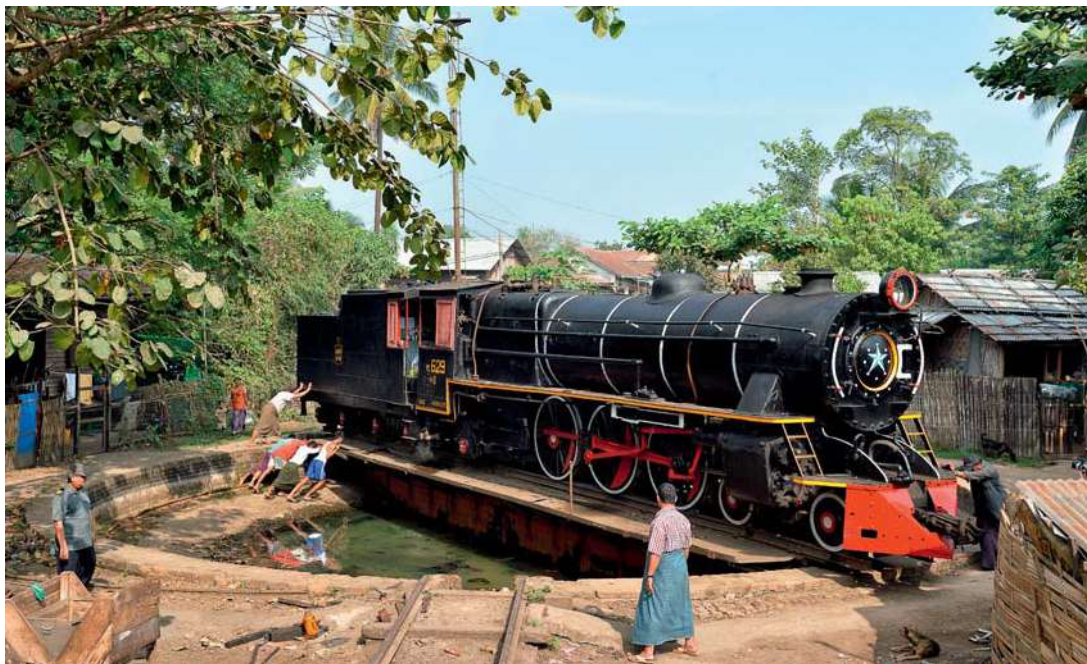
YC 629 wird am 15. Januar 2018 auf der wieder hergestellten Drehscheibe von Bago von Hand gedreht. Nach dem Monsunregen der letzten Tage musste bei schwülwarmem, windstillem Wetter das Wasser aus der vollgelaufenen Grube erst wieder abgepumpt werden.
