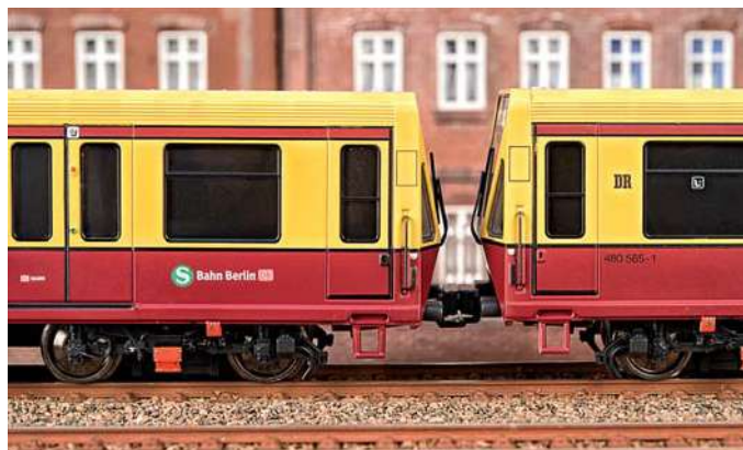
Mehrere Viertelzüge lassen sich über die kulissengeführte Nachbildung der Scharfenbergkupplung in realistischer Weise miteinander verbinden.
