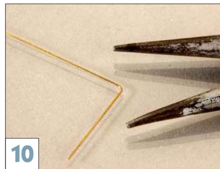
10 Um später einen rechten Winkel bei den Haltebügeln zu erzielen, ist ein leichtes Überbiegen notwendig.
