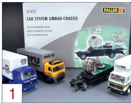
1 Das neue Umbau-Chassis ist für viele zweiaxelige Standard-Lkw-Typen geeignet.
