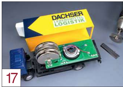
17 Für Lkw mit kurzen Nahverkehrs-Führerhäusern muss die Ladefläche gekürzt werden.
