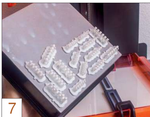
7 Ist der Druck abgeschlossen, hängen die Teile an der Montageplattform. Mit Hilfe des mitgelieferten Hebelwerkzeugs ...
