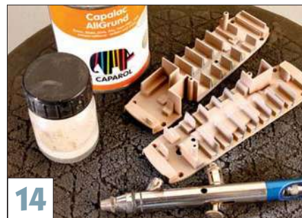
14 Vor dem Einfärben der Inneneinrichtung erfolgt noch eine Spritzlackierung mit weißem Haftgrund.
