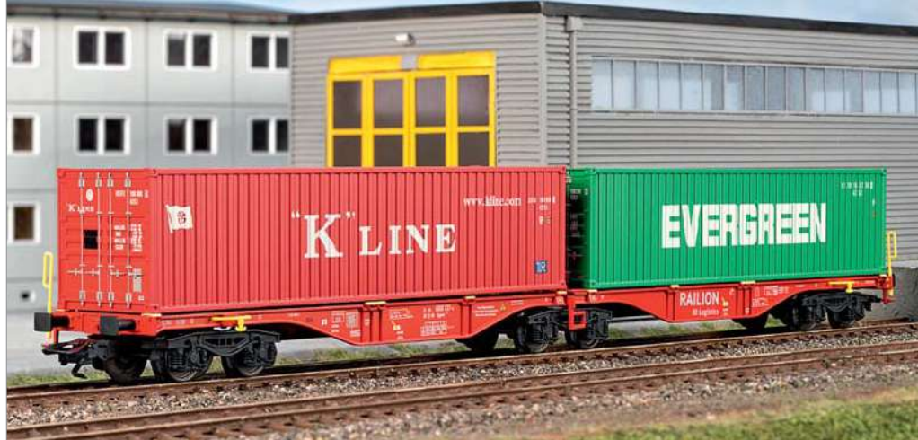
Im roten Farbleid von DB-Railion zeigt sich der mit zwei 40-Fuß-Containern beladene Sgrrs 733.
