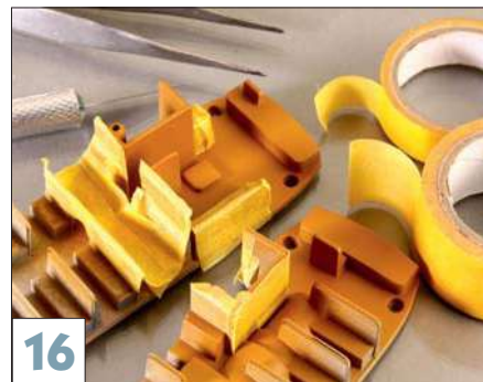
16 Dann werden sie vor dem nächsten Lackierung mit Tamiya-Abdeckband maskiert.
