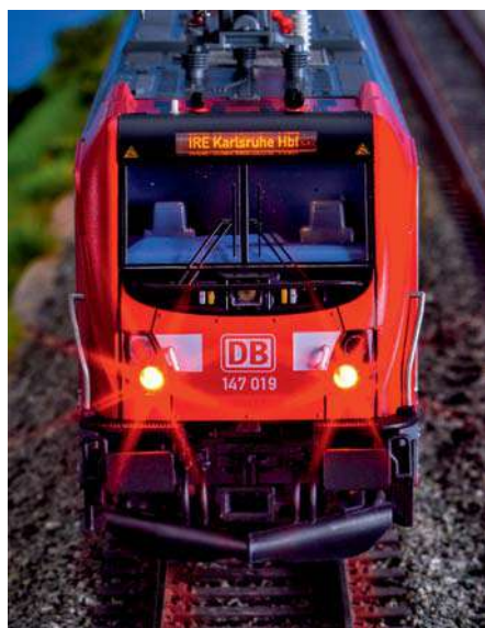
Die Lichtfunktionen entsprechen dem Vorbild und sind mit Decoder erweiterbar.
