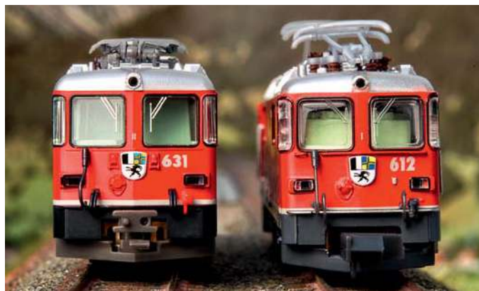
Das Kato-Modell (li.) ist ab Werk mit einer Mittelpufferkupplung ausgerüstet, die MDS-Version mit Standardkupplungen.
