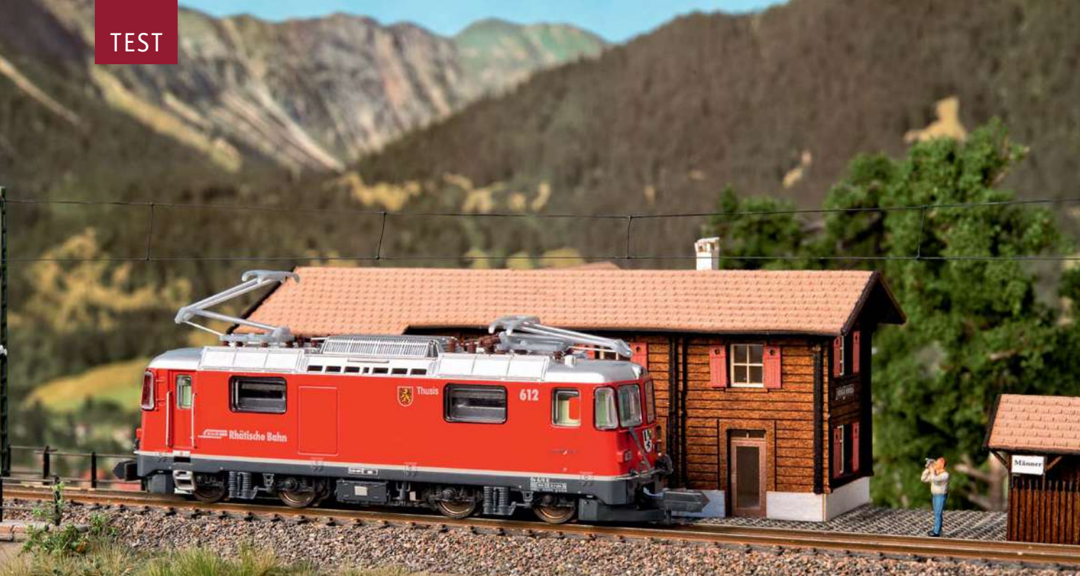
Das MDS-Modell der modernisierten Ge 4/4 II bietet Nachbildungen der Kastenabstützungen und der Führerstandsaufritte unterhalb des Rahmens.
