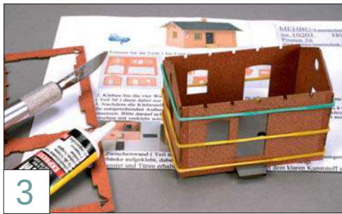
Der Rohbau des kleinen Gebäudes ist schnell zusammengefügt. Während der Weißleim trocknet, werden die Bauteile mit Gummibändern fixiert.
