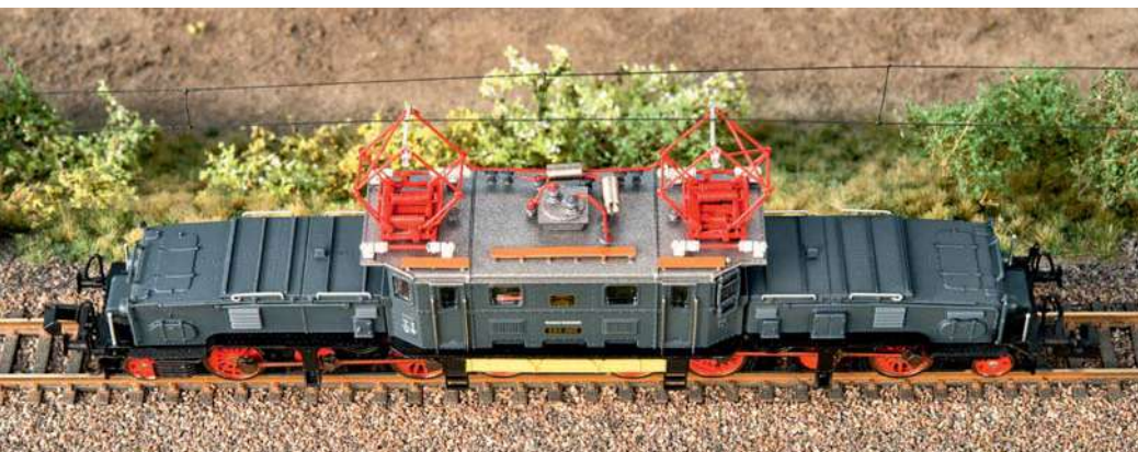
Die Reichsbahn-Version (E 98 005) zeichnet sich unter anderem durch abweichende Stromabnehmer mit einfachen Schleifstücken und aus feinem Draht gewickelte Spulen auf dem Dach aus.
