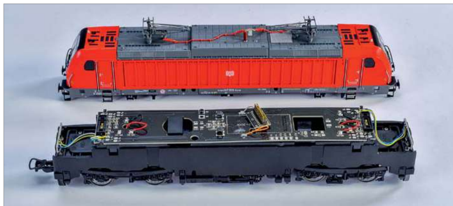
Das Gehäuse ist mühe- wie risikolos abzunehmen. Ein Digitaldecoder ist mit wenigen Handgriffen eingesetzt. Auch der Lautsprechereinbau ist wie üblich vorbereitet.
