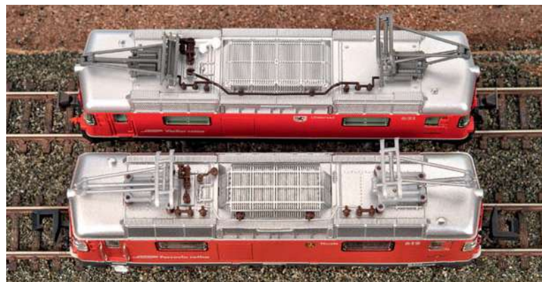
MDS (unten) bietet eine geätzte Abdeckung der Dachwiderstände und feinere Dachleitungen; Katos Stromabnehmer liegen besser auf.
