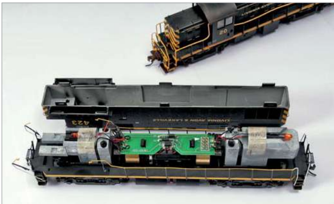
Nach dem Öffnen der Lok durch Zusammendrücken der Vorbauten und Abheben des Gehäuses offenbaren sich knappe Platzverhältnisse.
