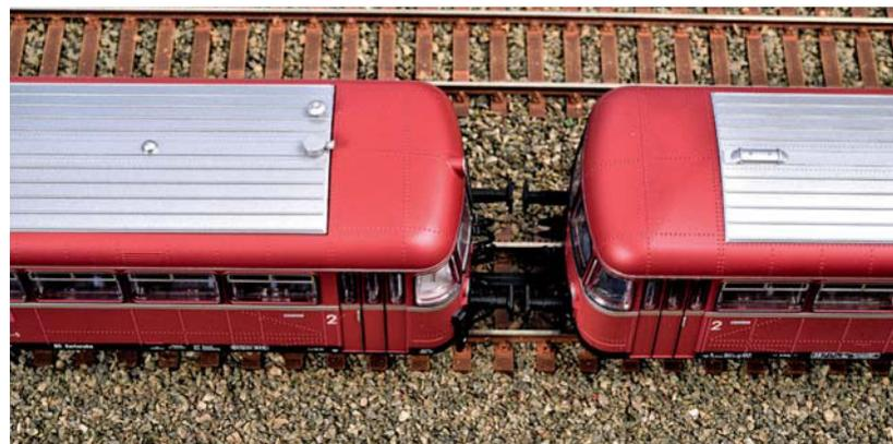
Die stromführende feste Kupplung zwischen Motor- und Steuerwagen ist angenehm dezent ausgefallen.
