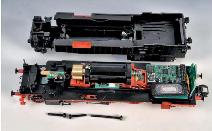
Unter dem leicht abnehmbaren Gehäuse verbergen sich Rauchgenerator, Decoder und Lautsprecher.
