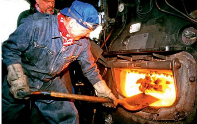
Rund eine Tonne Kohle pro Stunde schaufelt Emil Stalder bei einer Fahrt am 4. Januar 2001 in die gefräßige Feuerbüchse.
