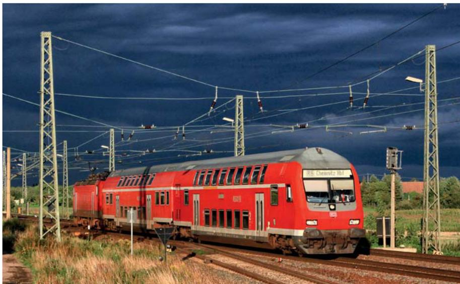
Alt und neu vereint: Eine RB von Elsterwerda nach Chemnitz Hbf entflieht am Abend des 16. August 2010 am Abzweig Bogendreieck Zeithain einem Gewitter. Eine 143 schiebt einen modernisierten DBuza 747 der ehemaligen DR und den Steuerwagen der Bauart DABpbzfa 762.
