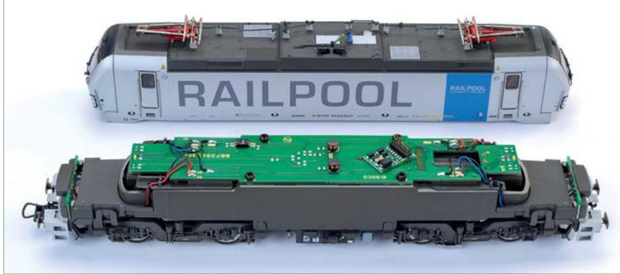
Nach Abziehen des Gehäuses offenbart sich ein gewohntes Bild: Unter Platine und Schnittstelle ruht der Motor, der Einbau eines Digitaldecoders ist vorbereitet.
