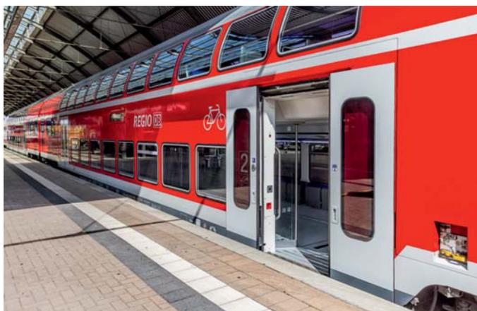
Ein DBpz 780.3 diente ab September 2015 in Sachsen-Anhalt als Erprobungsträger für neue Türmodule der Firma IFE im Planbetrieb.
