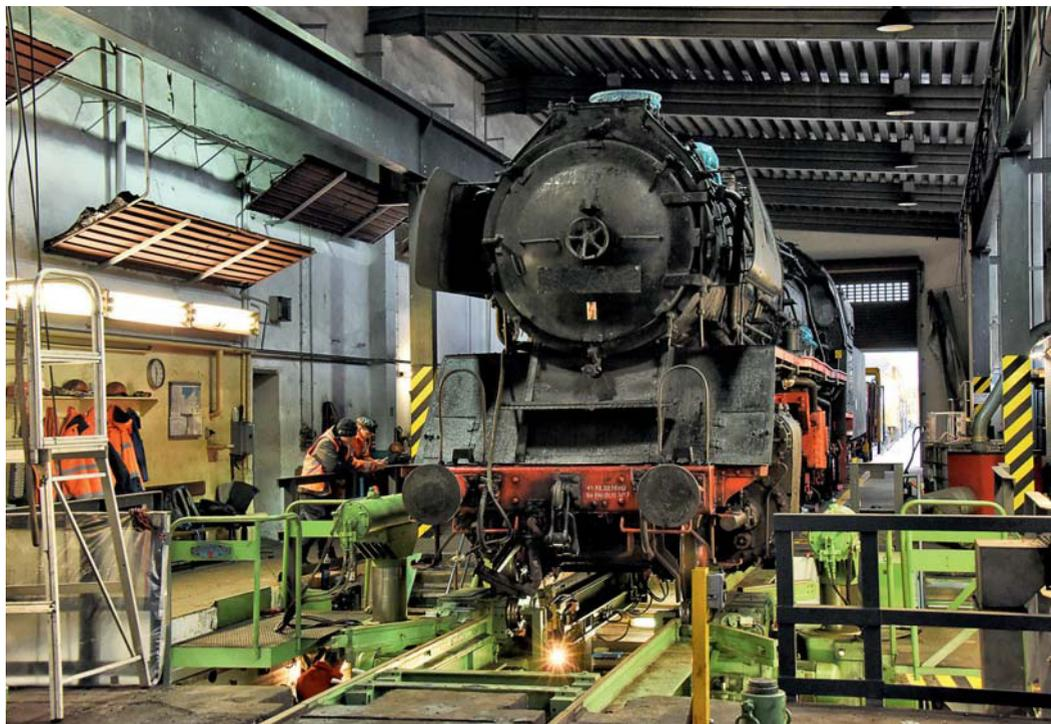
Am Morgen des 11. Dezember 2017 stand 50 3570 endlich auf der Unterflur-Radsatzdrehmaschine im Bahnwerk Neustrelitz.
