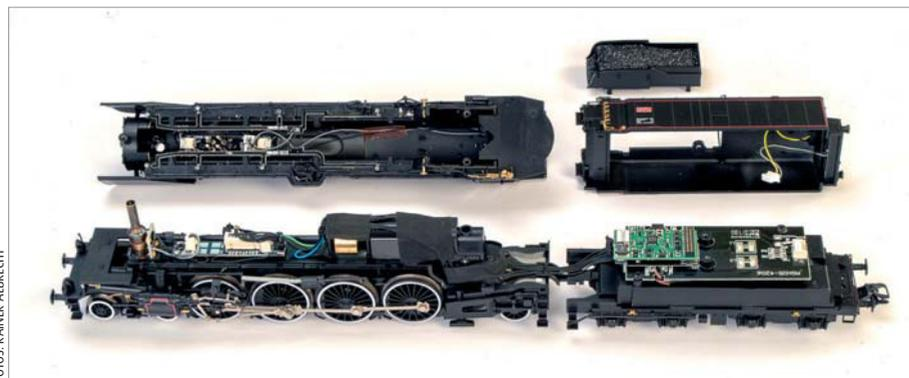
Gut zu erkennen sind der Raucheinsatz rechts, der in der breiten Feuerbüchse untergebrachte Motor sowie die im Tender verstaute Elektronik.
