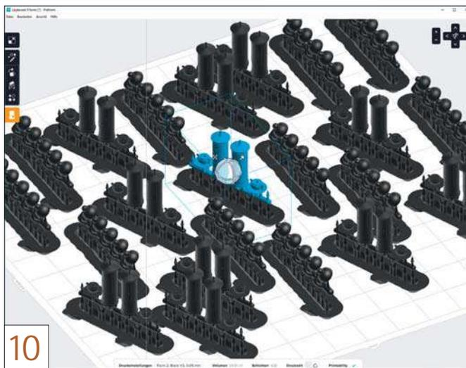
Da die Teile sehr klein sind, passt eine ganze Menge auf die Montageplattform. Die zufällige Verteilung sorgt dafür, dass die Silikon-schicht auf der Sicht-scheibe der Schale des Formlabs-Druckers gleichmäßiger abgenutzt wird und damit nicht so schnell abstumpft.
