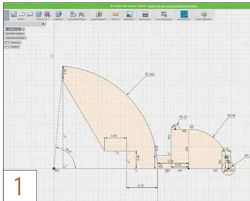
1 Viele 3D-Projekte beginnen mit einer zweidimensionalen Skizze. Bemaßungen und Abhängigkeiten definieren das Profil des späteren 3D-Objekts.
