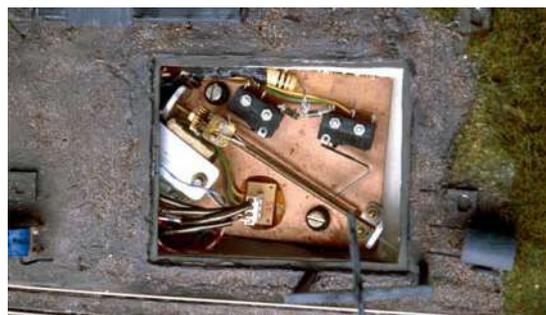
Zunächst muss man die offene Norderland-Lagerhalle entfernen, anschließend das Brettchen mit dem dort abgestellten Inventar abheben, dann zeigt sich das nicht zuletzt zur Funktion der Klappbrücke nötige Ensemble von Mikroprozessoren, Vorwiderständen und umgebautem Weichenantrieb mit einer erheblich verlängerten Gelenkwelle.
