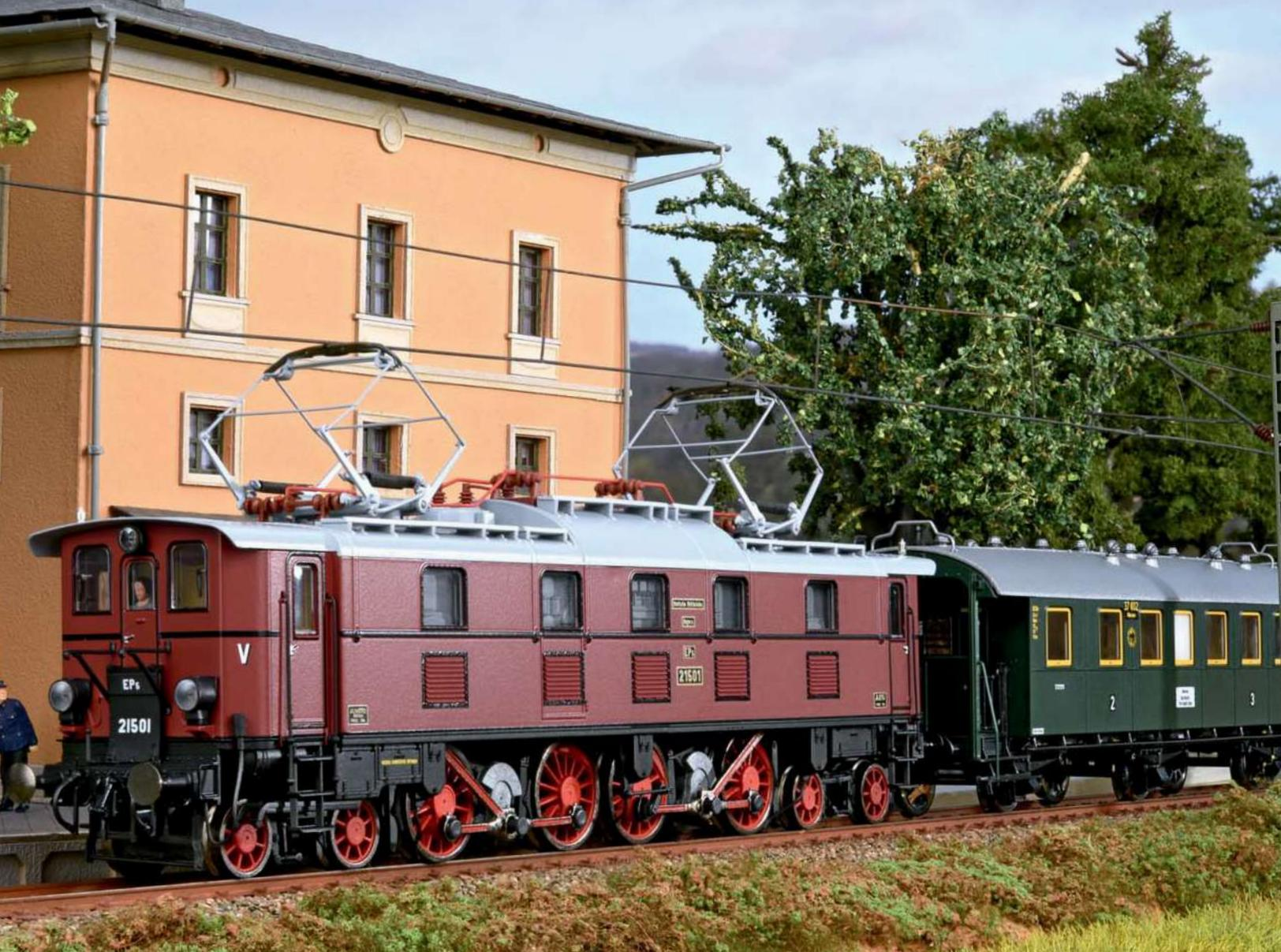
Ausgeklügelt ist das Modellfahrwerk: Die Stromabnahme erfolgt über alle Räder. Die Laufräder in den Drehgestellen sind höhenbeweglich gelagert, ebenso die beiden inneren Kuppelradsätze, bei denen der Antrieb über die Kuppelstangen geschieht. Trotz des komplizierten Fahrwerks erfreut ein absolut gleichmäßiger, taumel freier Lauf. Die Fleischmann-Lok übertrifft
