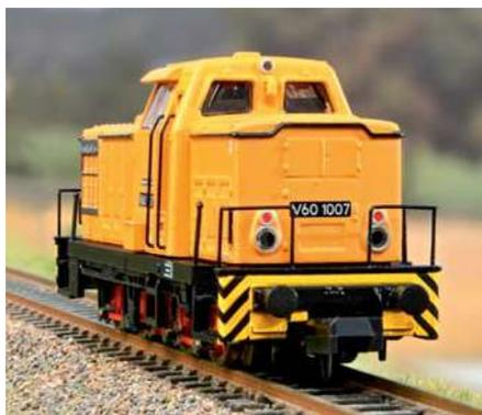
Feinste Metallgeländer und -griffstangen zieren Fronten und Führerstandsauftiege.
