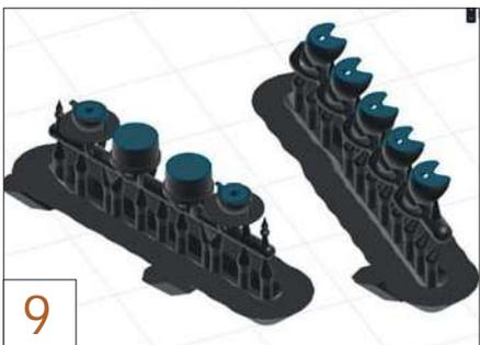
Tools des Druckerherstellers helfen mit einer Simulation dabei, die Teile korrekt auf der Montageplattform zu platzieren. Der Träger wird dabei von Stützstrukturen gehalten. Der plattenartige Unterbau hält das Teil später auf der Montageplattform fest.
