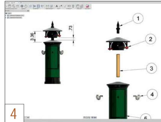
4 Explosionsdarstellungen des Programms können für Bedienungsanleitungen verwendet werden.
