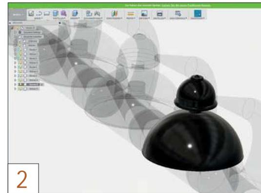
2 Durch Rotation entsteht aus dem Schnittbild das eigentliche 3D-Teil, in diesem Fall die Glocke des Lötewerks.
