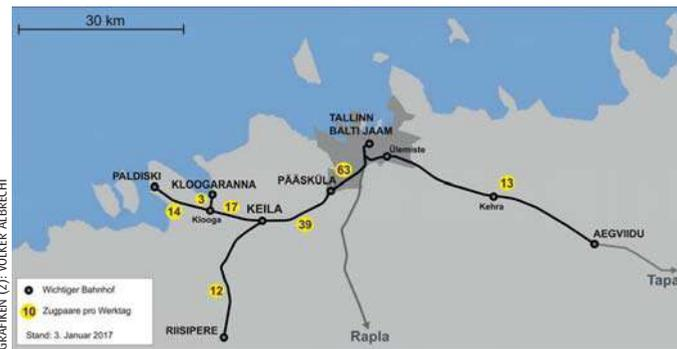
Nur im Nahbereich von Tallinn besteht ein 130 Kilometer langes, mit 3000 V-Gleichstrom elektrifiziertes Netz, das teilweise dicht befahren wird.
