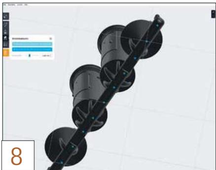
Die letzten Stützpunkte werden an der Unterseite eines Trägers platziert, die komplexen Stützen sind bereits Teil des Modells.
