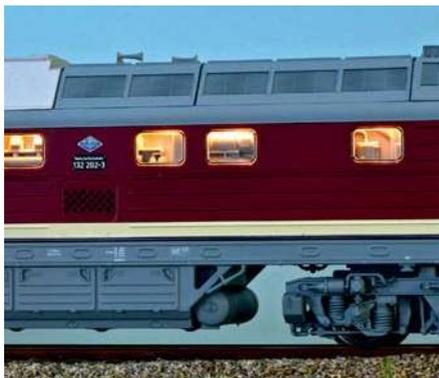
Die Maschinenraumbeleuchtung ist nach Einbau eines Decoders digital schaltbar. Analog ist sie per Jumper aktivierbar.
