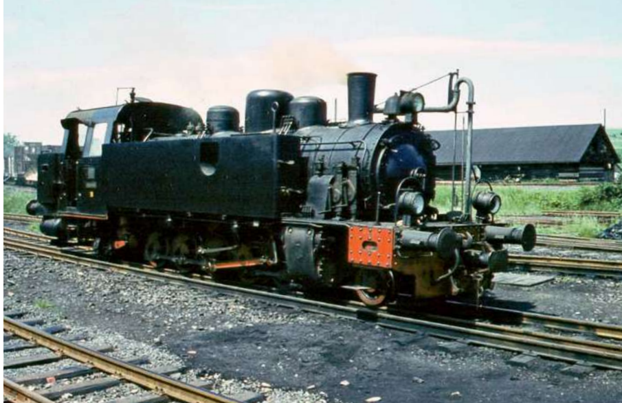
Die 1'E1-Lok 16 wurde aus einer 750-mm-Heeresfeldbahn-Schleppenderlok (Jung, 1941) umgebaut. Dabei erhielt sie die sehr üppigen Wasserkästen. Sie war die letzte Dampflok der KB.
