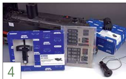
4 Der ab Werk installierte Raucherzeuger wird ersetzt. Ein automatischer Entkuppler und neue Schilder liegen ebenfalls bereit.
