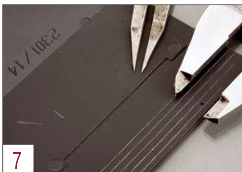
7 Auch an der glatten Dachunterseite lassen sich Fugen der hölzernen Kanten ergänzen. Dies geschieht mit der Anreißschieblere.
