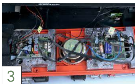
3 Vor dem Abziehen der Kabel von Decoder und Soundmodul empfiehlt sich eine Kennzeichnung der Steckverbindungen.
