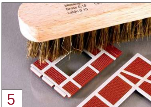
5 Beim Gravieren entstehen Grate, die beim Überbürsten mit einer weichen Messingbürste aber einfach beseitigt werden können.
