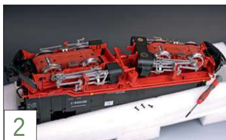
2 Das Fahrgestell ist mit nur wenigen Schrauben am Aufbau befestigt. Praktisch ist die Verwendung einer Lokliege (Eigenbau).
