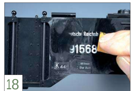
18 Für die Neu-Beschilderung sollten die LGB-Angüsse nass abgeschliffen werden.
