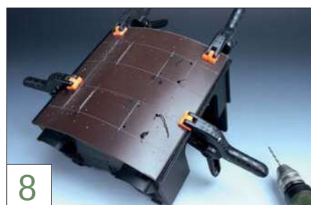
8 Nach dem Anreißen der Ausschnitte für die Klappen werden in der neuen Ein-Millimeter-Dachplatte die Ecken vorgebohrt.
