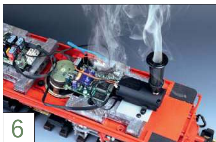
6 Der für den Verdampfer notwendige Taktgeber ist in dem Sound-Modell schon vorhanden. Nach dem Anschluss folgt ein Testlauf.
