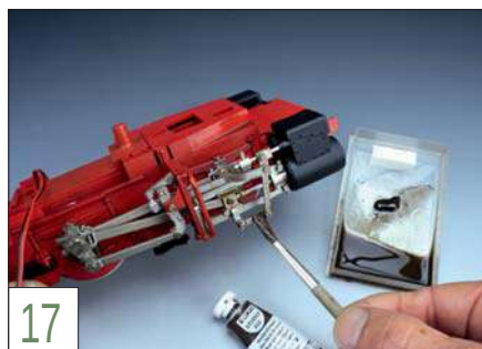
17 Nun wird eine Lasur aus Feuerzeugbenzin und der Ölfarbe Vandyckbraun aufgetragen.
