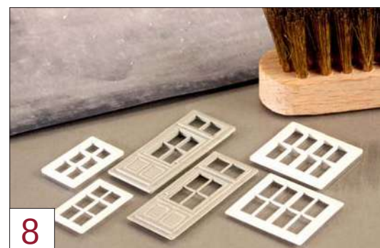
8 Fenster und Türen lassen sich durch rückseitiges Abziehen auf einem planen Schmirgelbogen dünner schleifen.
