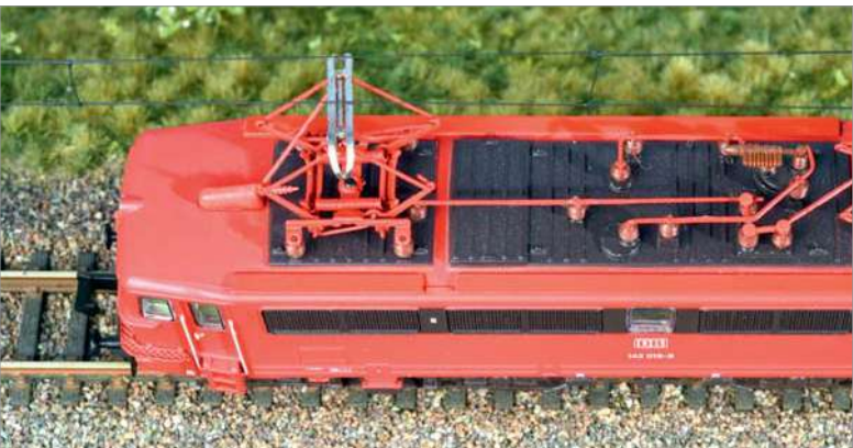
Auf dem Dach gefallen vor allem die der DR-Bauart entsprechenden Stromabnehmer, den Laufbrettern fehlt eine Riffel- oder Bohlenstruktur.
