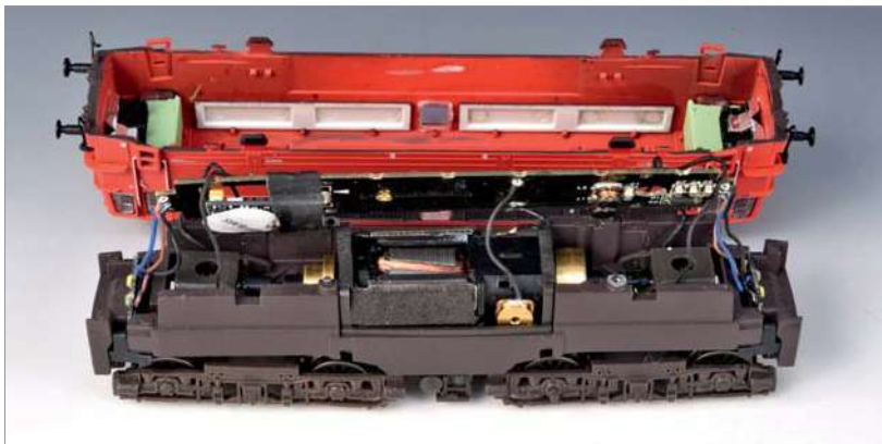
Aufgeräumt und zeitgemäß zeigt sich das Lok-Innere. Dem schrägenuteten Motor hilft eine kleine Schwungmasse.
