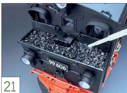
21 Die Echtkohlefüllung wird mit stark verdünntem, transparentem Modellbaulack fixiert.
