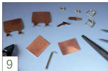
9 Aus Kupfer- und Messingblech lassen sich neue Luken und Scharnierteile anfertigen, ebenso vorbildgetreue Dachhaken.
