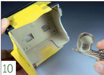
10 Die obere Hälfte des Führerhauses wird von innen mittelgrau lackiert.
