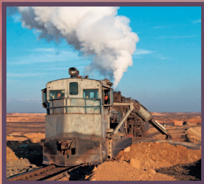
Der dampfbespannte Pflug sorgt in regelmäßigen Abständen dafür, dass der unmittelbare Gleisbereich auf den Halden vom Abraum befreit wird.
