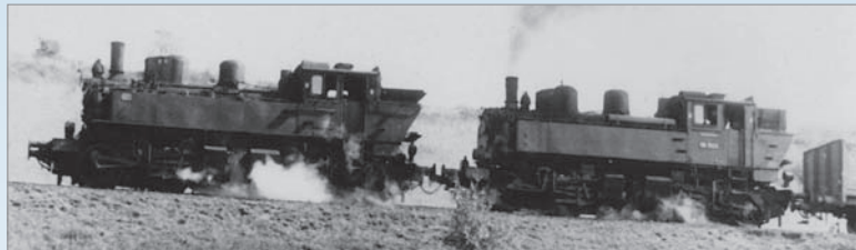
Die „Kreuzspinne“, die Windbergbahn-Lok 98.0, war die einzige normalspurige Meyer-Gelenklok Sachsens, hier 98005 und 98011 um 1957.
