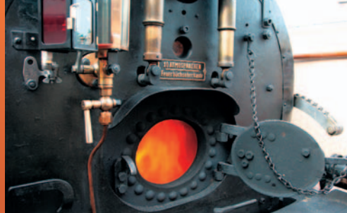
„Die Feuerung ist gutmütig, aber niedrig nach dem Einschaufelprinzip zu beschicken“, so Hanspeter Landenberger, Lokführer und Heizer auf der Genf.
