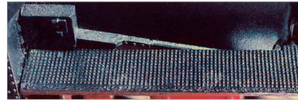
So wirkt der nachgerüstete Umlauf an einer H0-52.
