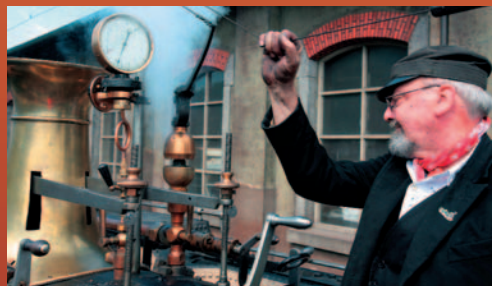
Zwei kurze Pfeiffe bedeuten Bremsen lösen, drei Pfeiffe Bremsen anziehen. So kommuniziert der Lokführer mit den Bremsern auf den historischen Wagen.
