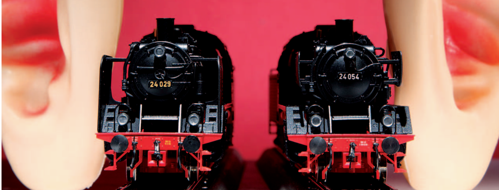
Die Stirnansicht macht die Unterschiede zwischen DRG- und DB-Version an der Rauchkammer deutlich.
