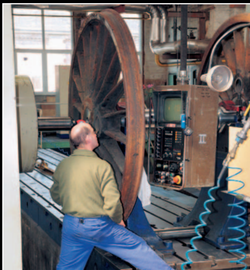
Bohren mit Präzision: Zwei große Treibradsätze werden am 2. April 2009 bearbeitet.
