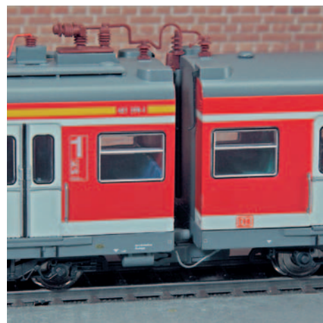
Die grauen Elektrokupplungen finden im Boden der Endwagen Platz. Angenehm fällt der geringe Abstand zwischen den Wagen auf.
