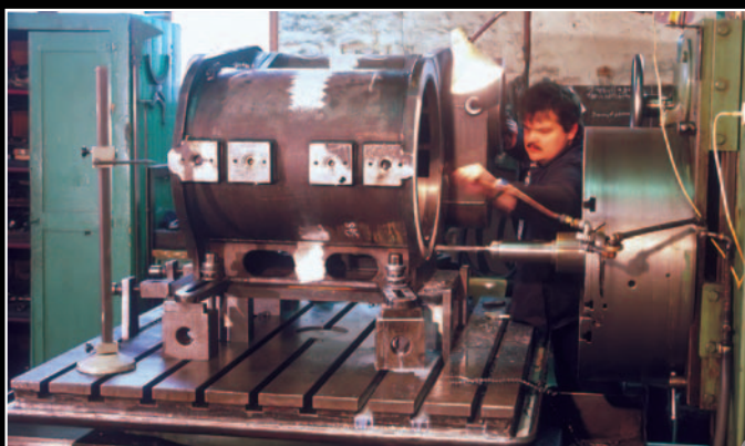
Ein neuer geschweißter Dampflokzylinder erhält Anfang der 1990er-Jahre noch Bohrungen für die Zylinderdeckel.
