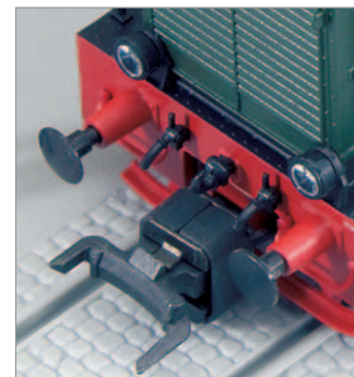
Das am Magnet befestigte Metallplättchen hebt den Bügel an.
