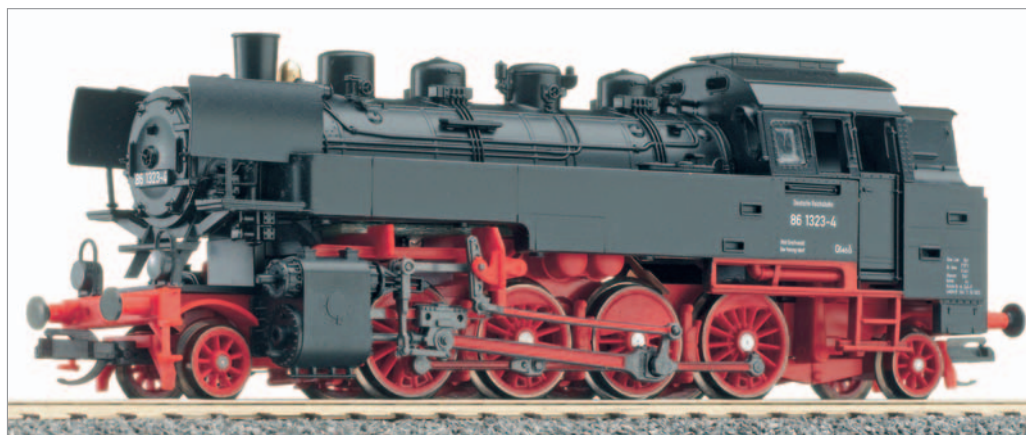
Gegen den lästigen Seewind ließ die Deutsche Reichsbahn bei den Usedom-86 Witte-Bleche anbringen.
