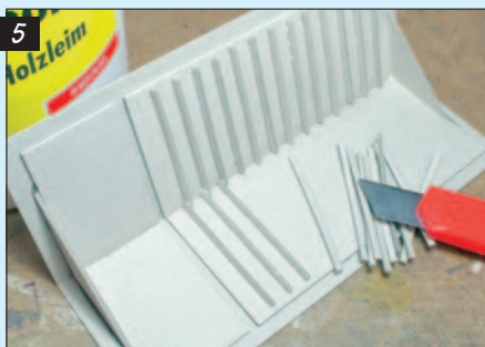
5 Das Eigenbau-Dach des Lokschrupps entsteht aus Graupappe und wird ausreichend versteift.
