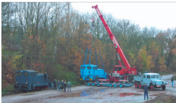
Am 28. Oktober 2008 wird die Lok von einem Kran der Berufsfeuerwehr Chemnitz auf den Culemeyer-Tieflader gehoben, um einen Tag später auf das vorbereitete Gleisstück gesetzt zu werden.
