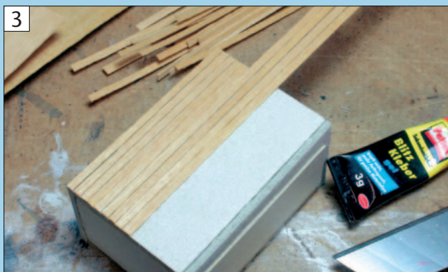
Die Modellbretter für die Außenhaut sind rund drei Millimeter breit. Sie bestehen aus Furnierholz und werden auf den Karton geklebt.
