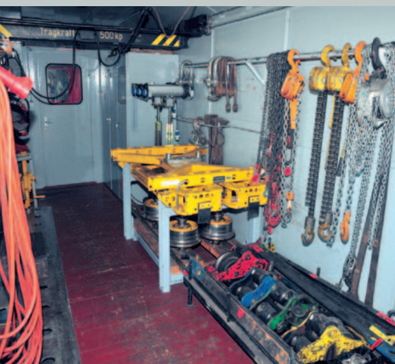
Blick in den Gerätewagen: In der Mitte erkennt man ein Hilfsdrehgestell der Bauart Robel (gelb) und davor ein „Woroschilowgrad“.
