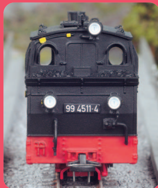
Ein nettes Detail ist das wegen der Heberleinbremse versetzte dritte Spitzenlicht.
