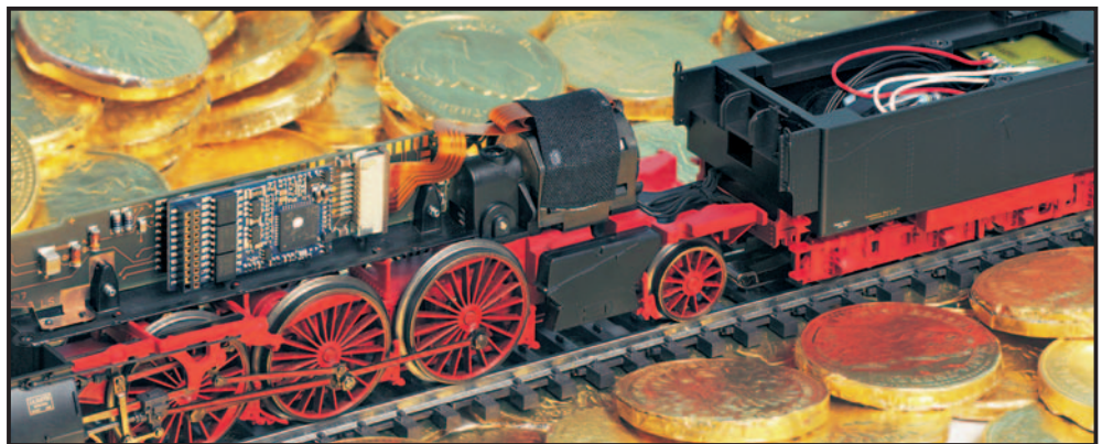
Der Softdrive-Sinus-Motor sitzt hinten, die Regelelektronik und der Decoder vorne in der Lok. Im Tender residiert der Lautsprecher.
