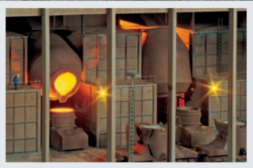
Abstich: Durch Kippen des Konverterbehälters gelangt die Stahlschmelze in die Pfanne.
