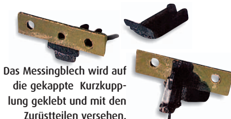
Aus der Ganzzugkurzkupplung und den Pufferträger-Zurüstteilen entsteht der Einsatz.
