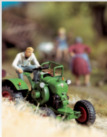
Der Allgaier-Schlepper R 22 entstand nach Vorbildfotos weitgehend im Selbstbau aus Polystyrol, Draht und Messingblech.
