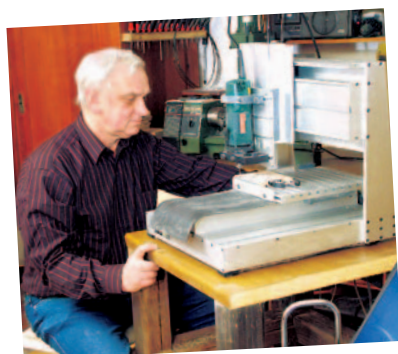
Der Meister richtet seine CNC-Fräse in der Kellerwerkstatt ein. CNC steht für „computerized numerical control“, also rechnergestützt und -kontrolliert.
