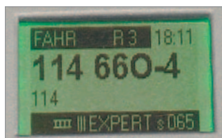
Lok 114660 (Adresse 114) fährt um 18:11 Uhr in der 65. Fahrstufe. Im Expert-Modus darf der Name der Lok oder des Magnetartikels bis zu acht Zeilen lang sein!
