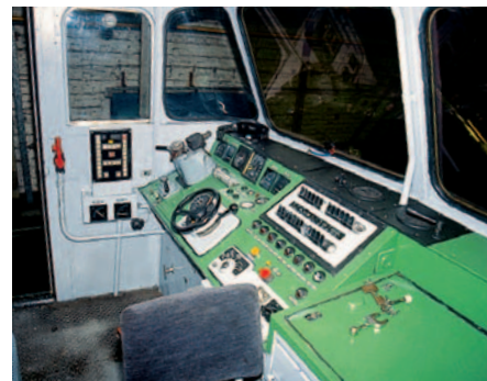
Der Arbeitsplatz des Lokführers in der belgischen Baureihe 16 ist links. Zahlreiche Fenster ermöglichen eine sehr gute Sicht.
