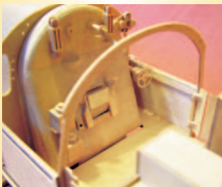
Der Führerstand ist noch unbedacht, doch erkennt man die Stehkesselnrückwand nebst Feuertür und Kesseldruckmessern.
