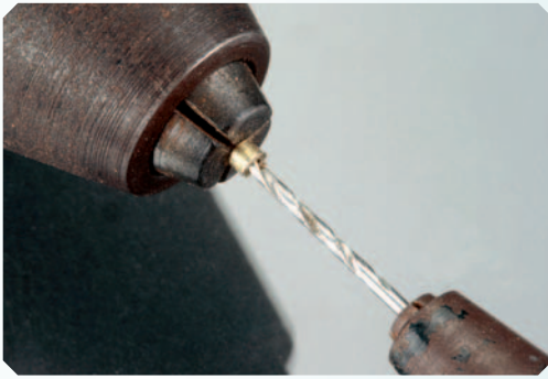
Kleine Drehteile wie zum Beispiel Buchsen oder Schollen lassen sich auch mit Hilfe einer Minibohrmaschine herstellen.
