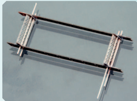
Die einzelnen Stufen werden dann mit durchgesteckten Drahtstücken zwischen den beiden Seitenteilen fixiert.
