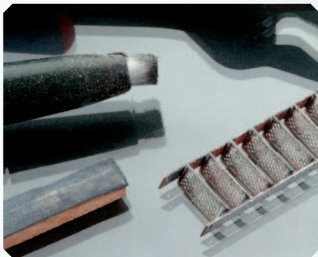
Sind alle Stufen verlötet, kappt man die Drähte mit einem Seitenschneider.
