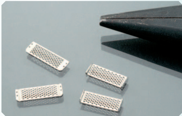
Die Enden der Aufstiegstritte werden mit einer kleinen Spitzzange nach oben abgewinkelt.
