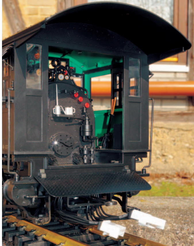
Eine massive Stange sorgt für die mechanische, zwei Kabelbäume mit Steckern sorgen für die elektrische Lok-Tender-Verbindung.
