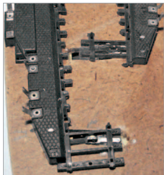
Ein harter Stelldraht (re.) ist für die korrekte Endlage des eingebauten Antriebs (o.) notwendig.
