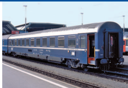
Die SBB gaben bei der Schweizer Industrie 1978 20 klimatisierte Liegewagen in der Bauform der Eurofima-B mit Fiat-Drehgestellen in Auftrag: Bcm 61 85 50-70 100 in Zürich HB, 1996.
