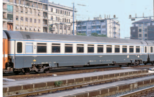
Die Zweite-Klasse-Nachbauserie der FS im GC-Anstrich zeigt gegenüber ursprünglichen Eurofima-Wagen Türen mit kleineren Fenstern, dickere Fensterrahmen und Dachsicken bis zum Rand.
