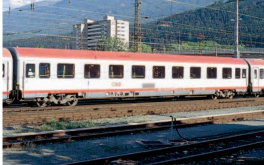
„Upgrading“ nennen die ÖBB Farbwechsel und Umbauten am Z1-Altbestand: Aus Eurofima-Amz 19-71 werden Ampz 18-71 mit Businessabteilen und Großraum (Innsbruck Hbf, 2007)
