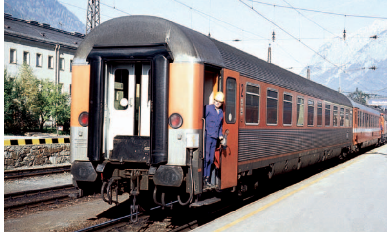
Die DB ließ 1972 bei LHB je einen AB- und einen B-Wagen nach UIC-Z1 bauen. Der ABwüzm 227 diente als Nr. 9s der Eurofima-Vorerprobung. Als Kurswagen im Steiermark-Express wird er 1984 in Bischofshofen rangiert.
