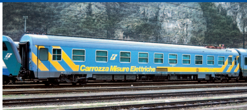
Die italienischen Staatsbahnen FS ließen den AB-Prototyp Nr. 7 1985 durch den Waggonbauer Casaralta und die E-Lok-Hauptwerkstätte Foligno in den elektrotechnischen Messwagen VIme 6083 99-99012 umbauen.
