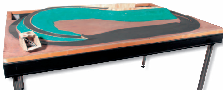
Eine Sperrholzplatte mit Geländekontur aus Styrodur ergibt ein leichtes und dennoch tragfähiges Gebilde.
