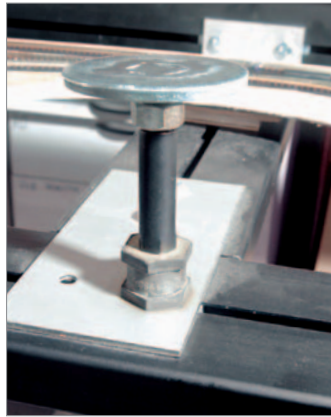
Auch die Stützen lassen sich natürlich verschieben und in der Höhe anpassen.
