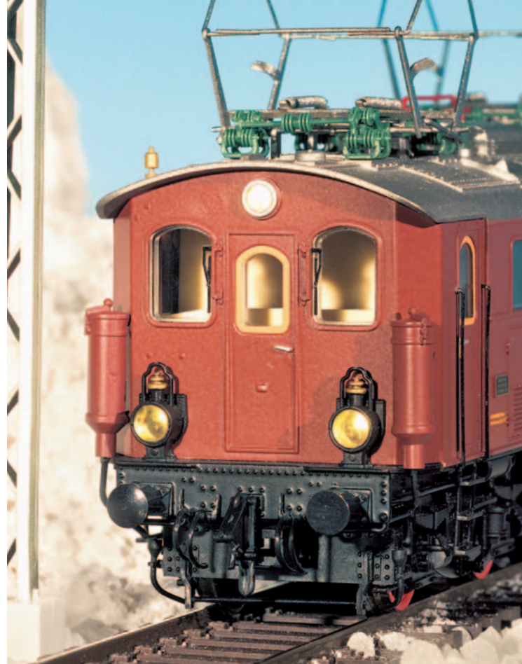
Warmweiße LED erzeugen ein angenehmes Licht. Die obere Lampe war allerdings ein Sondersignal.
