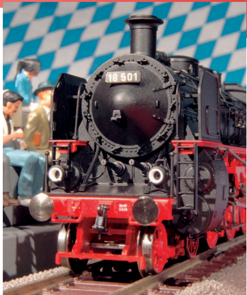
Gestatten: 18501 aus der Serie k in 87-facher Verkleinerung mit korrekten zwei Spitzenlichtern und hoch angebrachtem Loknummernschild.
