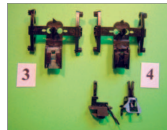
Den NEM-Schacht klebt man mit Sekundenkleber ein (3) und lackiert ihn in Mattschwarz (4).
