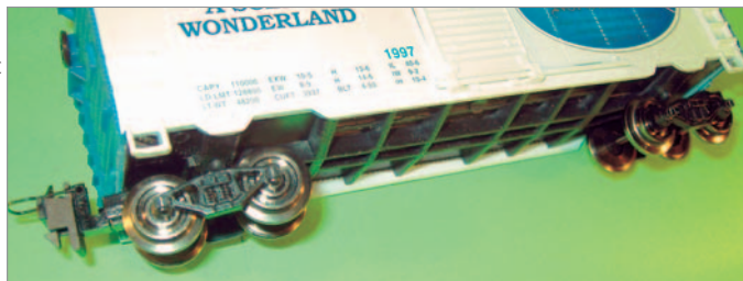
Mit den neuen Radsätzen rollt der Wagen sicher auf Trix-Express-Gleisen.
