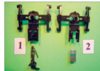
Die alte Kupplung wird samt Rastnase entfernt (1), die Aufnahme zurechtgefeilt (2).
