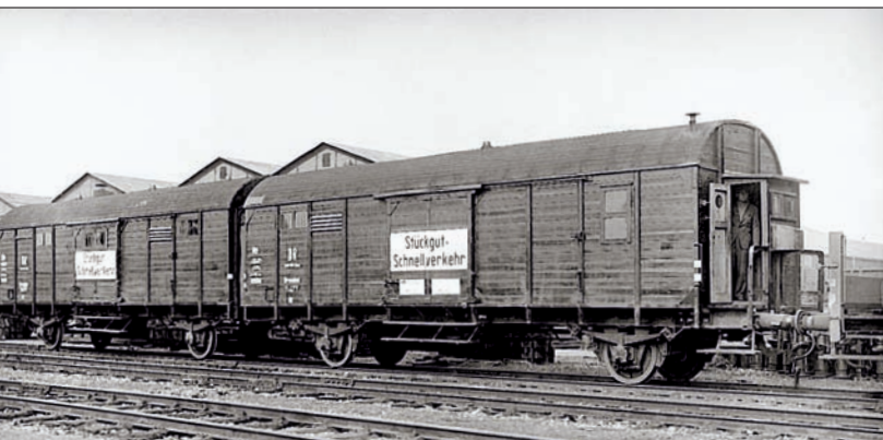
Bi-Zone: Die typische Münsteraner Nachkriegs-Leigeeinheit besteht aus zwei G11-Wagen, Gattungsbezirk Dresden, mit und ohne Bremserhaus.
