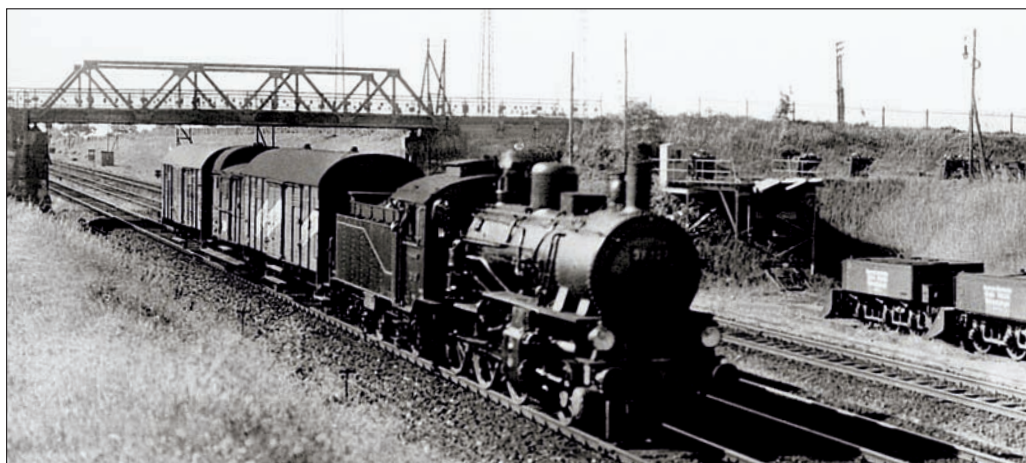
Juni 1933: Die Stettiner 37127, eine preußische P6, hat eine Leigeinheit mit beigestelltem G-Wagen am Haken.
