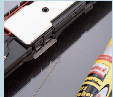
Vergleich zwischen ursprünglichen Tritten von Roco (unten) und den nachgerüsteten (oben).
