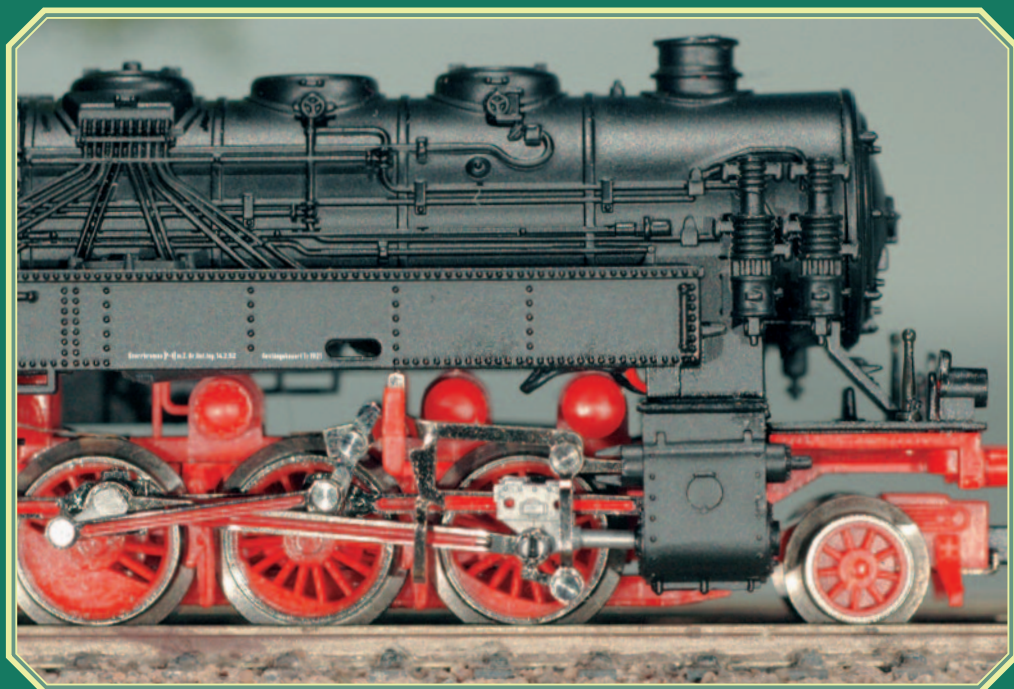
Sehr gut gefällt der Kesseldurchblick bei diesem 1:160-Modell. Das Gestänge aus Metall wurde vom alten Arnold-Modell übernommen, wird unter Hornby jedoch brüniert.
