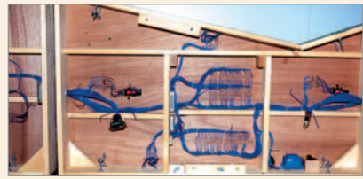
Bahnhofssegment Reichelsheim: Die Untersicht offenbart die Rahmenbauweise und die recht aufwendige Verkabelung.
