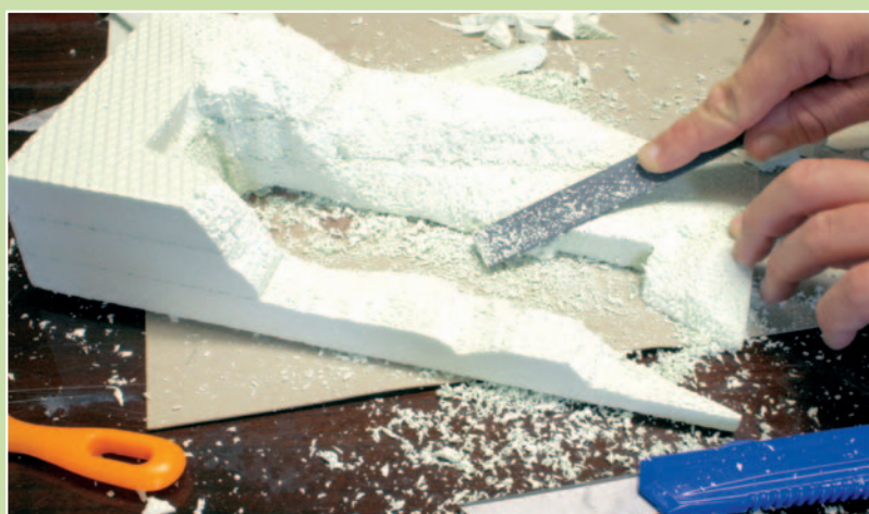
Mit der Raspel lässt sich Styrodur gut bearbeiten. Die Krümel laden sich elektrostatisch weit weniger auf als bei Styropor.
