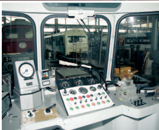
Am Führertisch des historischen CFL-Tw wurde beinahe alles erneuert und modernen Anforderungen angepasst.
