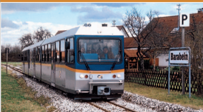
Für die OSE baute Stadler ein dreiteiliges Fahrzeug in Stahl-Leichtbauweise. Die maximale Achslast beträgt 6,3 Tonnen.
