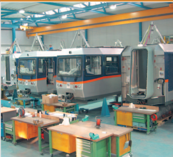
Serienfertigung en miniature: Die vier Zahnrad-Tw entstehen viel mehr im Manufaktur-Betrieb.
