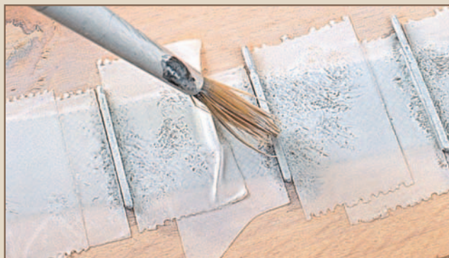
Bevor die Pfosten mit dem Pinsel grundiert werden, deckt man das Ätzteil mit Tesafilmstücken ab.
