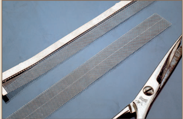
Für die Aufstellung als Gartenzaun musste sich das Ätzteil eine Reduzierung der Höhe gefallen lassen.
