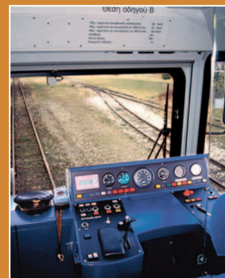
Der moderne Führerstand ist bereits griechisch beschriftet. Die Frontscheibe kann zur Evakuierung geöffnet werden.
