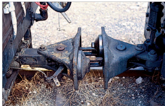
Scharfenbergkupplung leichter Bauart der BZB mit frei ausgefahrenen Kupplungsösen (betrieblich nicht vorkommende Stellung!)
