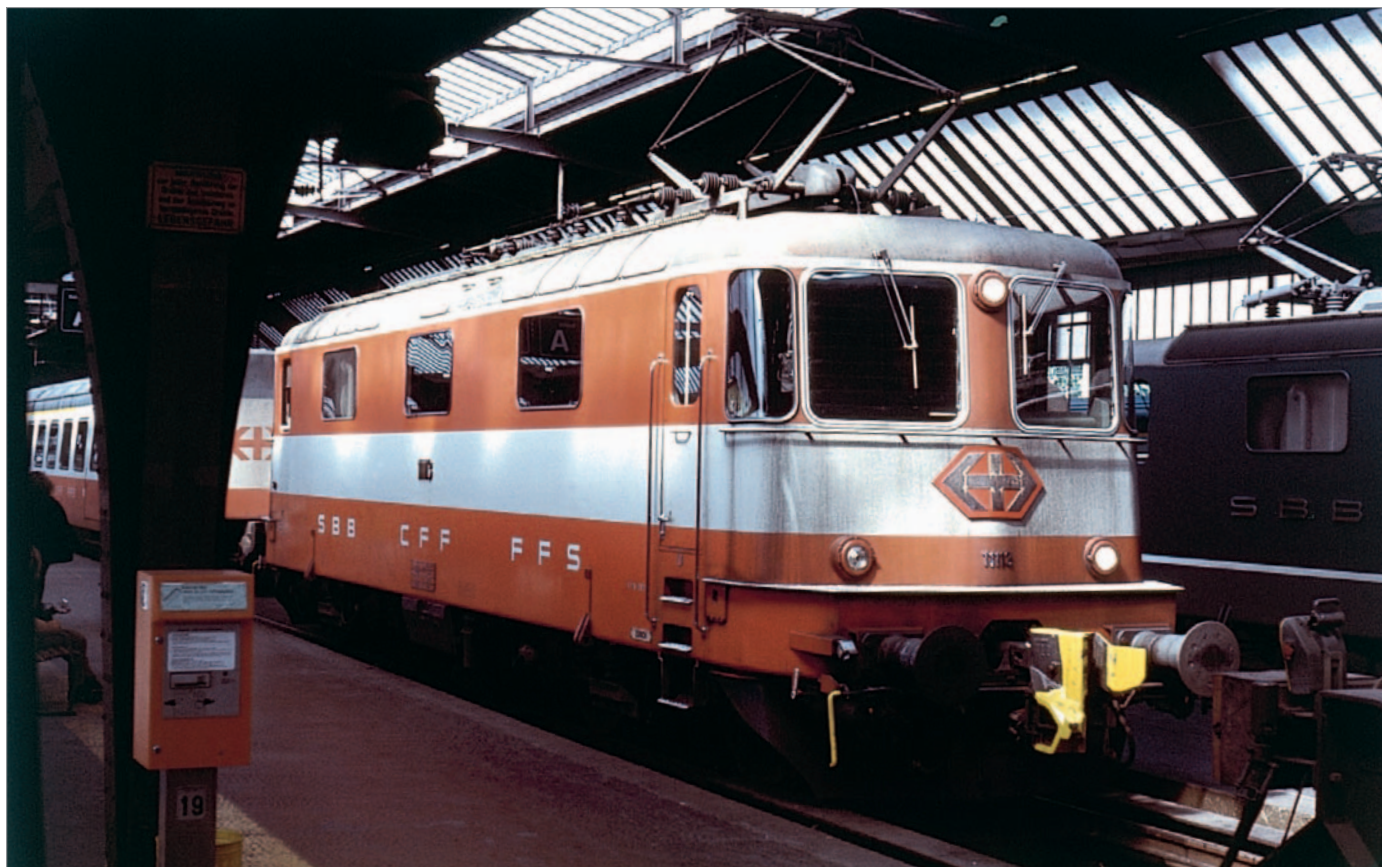
Für den Swiss-Express wurden acht Re4/4 II mit Unikutpler bestückt: Re4/4 II 11113 mit vorgestrecktem Stoßbalken (1981).
