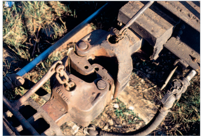
Ausgeschlagene US-Güterwagen-Klauenkupplungen mit viel Längsspiel führen im Zuglauf verstärkt zu Zerrungen und Auflaufvorgängen.
