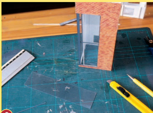
9 Erst jetzt werden die großflächigen Scheiben, die aus transparentem Polystyrol bestehen, eingeklebt.
