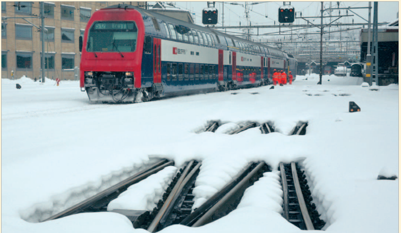
Deutlich ist die Wirkung der Weichenheizung zu erkennen, auf die es vor allem zwischen Zunge und Stockschiene ankommt.
