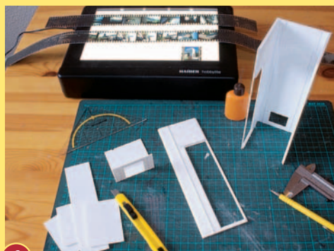
6 Sandwich: Jede Seite des Aufzugsturms erhält einen dreischichtigen Aufbau aus Polystyrolplatten.
