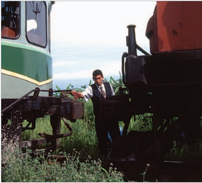
Kuppeln mit Krawatte: Die kuppelbereite Offenstellung der Klauenkupplung lässt sich von der Seite her mit dem Drehgestänge herbeiführen.
