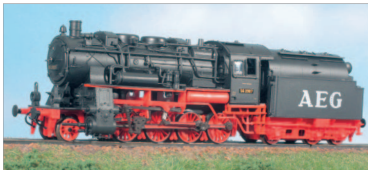
Rückkehrer: Die 56.25-56 wurde mit einer Kurzkupplungskulisse ausgestattet.
