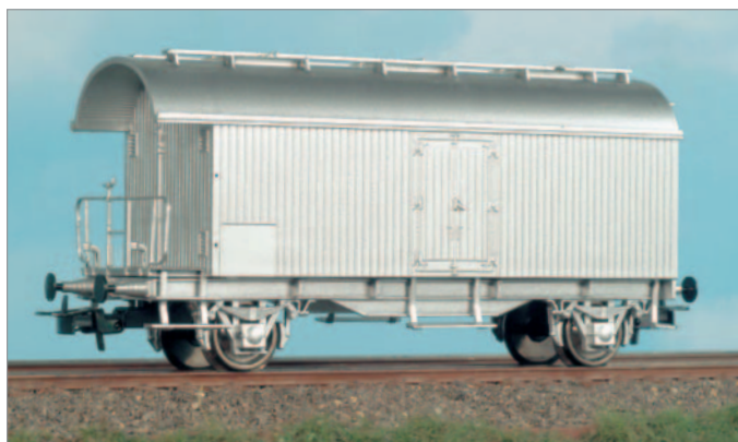
Der Bell-Kühlwagen erhielt eine neue Dachform.
