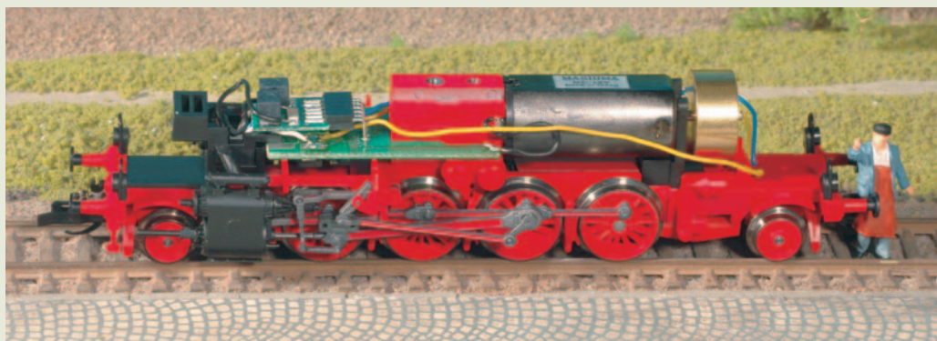
Das kompakte Innere: Der Masha-Motor treibt über Schnecke und Strinräder in gekapseltem Getriebe alle Treibräder an.
