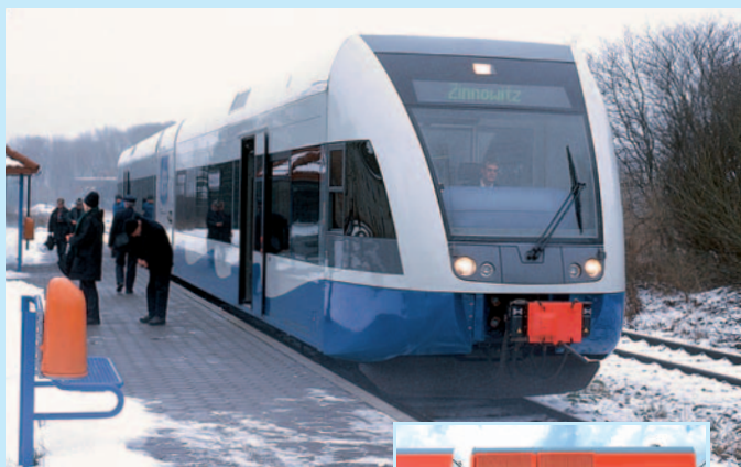
BR 646: Der Antrieb ist im Mittelteil (r.) untergebracht. Die Usedomer Bäderbahn setzt baugleiche Tw ein.
