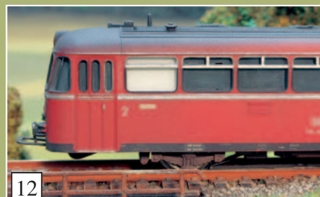
12 Diskussionswürdiger Kompromiss: Die Scheiben aus Cellon werden in Anthrazitgrau lackiert.
