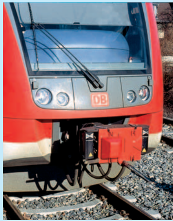
Moderne Scharfenberg-Kupplungen fürs schnelle Kuppeln übertragen auch alle Brems- und Steuerinformationen.
