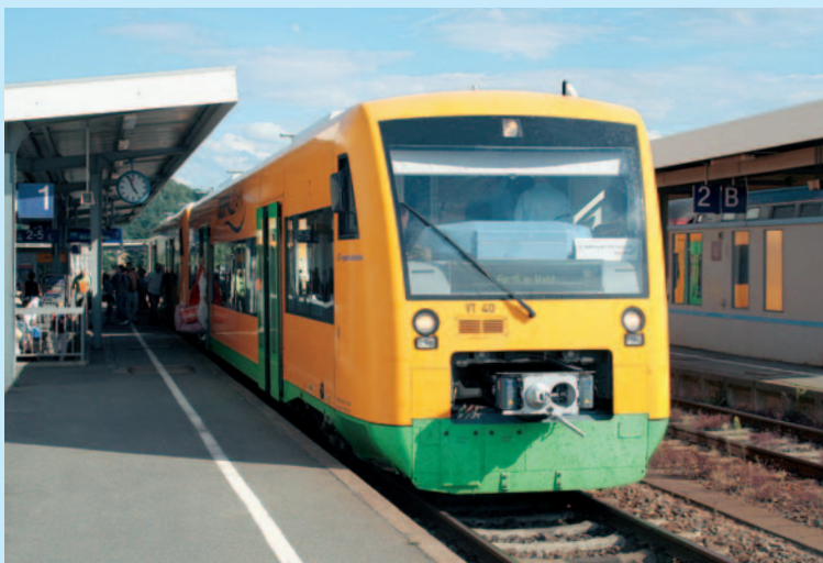
Schwandorf: Regioshuttle der Oberpfalzbahn haben automatische Kupplungen.
