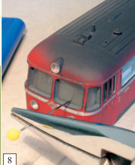
8 Mittels einer erhitzten Stecknadel entstehen die Bohrungen zur Befestigung der Scheibenwischer.
