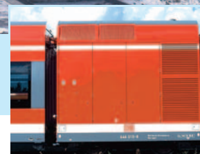
BR 646: Der Antrieb ist im Mittelteil (r.) untergebracht. Die Usedomer Bäderbahn setzt baugleiche Tw ein.
