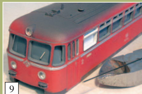
9 Vorbildgerecht: Der Scheibenwischer sitzt beim VT95 nur an einer Front in Fahrtrichtung rechts.
