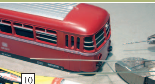
10 Die Fensterschutzstangen des Packabteils entstehen aus Viessmann-Fahrleitungsdraht.
